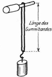
Abb. 123. Ausdehnungsversuch mit einem Gummiband.
