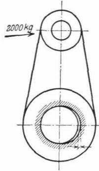
Abb. 69. Übergroßes Lagerspiel bei einer abgenutzten Maschine.
