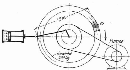
Abb. 67. Dampfmaschine mit Schwungrad zum Antrieb einer Pumpe.
