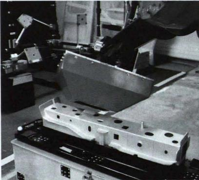
Abb. 1: Optische Sensoren zur Vermessung von Bauteilgeometrien: robotergeführt in der Flugzeugindustrie (links) und handgeführt in der Automobilindustrie (rechts).
