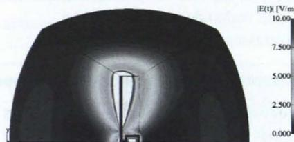
Abb. 2: Wellenausbreitung bei induktiv gekoppelter Transponder-Antenne
