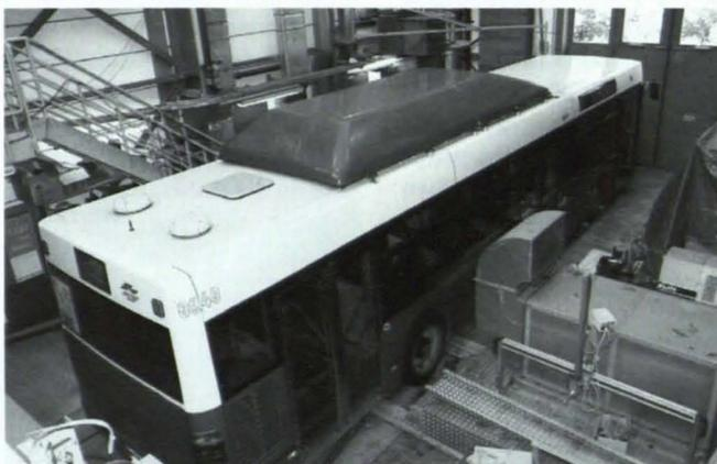
Dynamischer Rollenprüfstand der TU-Graz für schwere Nutzfahrzeuge bis 38 Tonnen und 360 kW mit Vollstrom-CVS Anlage (CVS nicht im Bild)
