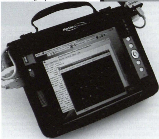
Abb.2: Ein Mobiler Demonstrator bestehend aus einer Stereo-Konfiguration und einem Mini-Tablet-PC für Anwendungen in „structure and motion“.
