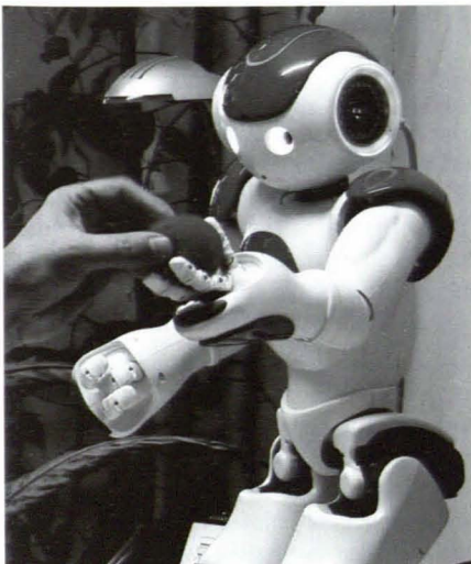
Abb.3: Greifen (a) und Betrachten (b) eines Objektes – Sprachausgabe „this is a red object“.
