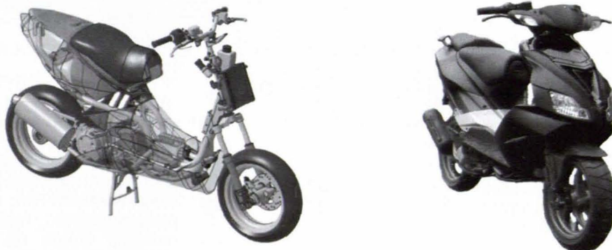
Abb.2: Fahrzeug (links: Konstruktion mit CATIA V5; rechts: straßentaugliches Fahrzeug)
