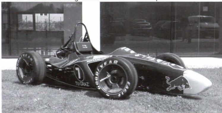
5. Rennboliden. Im April wurde der Tankia 2008 beim Rollout im Congress Graz zum ersten Mal der Öffentlichkeit präsentiert. Wie in den vergangenen Jahren setzen wir auf ein Carbon-Monocoque und einen Yamaha R 6 Motor. Der Motor wurde von uns am Prüfstand optimiert, wobei besonderer Wert auf Kraftstoffverbrauch und Fahrbarkeit gelegt wurde. So ist das Gas des Tankia
