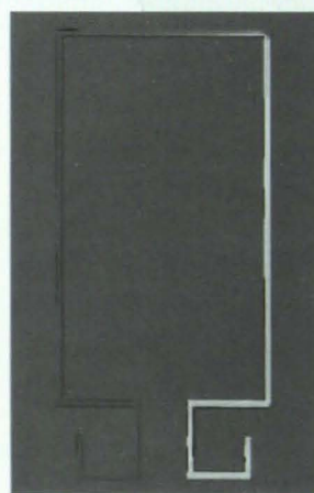
Stromdichte einer Micro-Strip-Schleife
