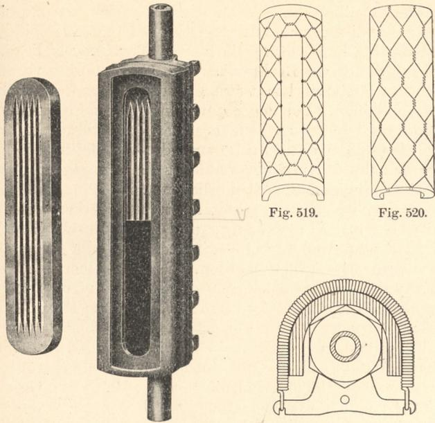
Fig. 518. Klingersches Reflektionswasserstandsglas.
