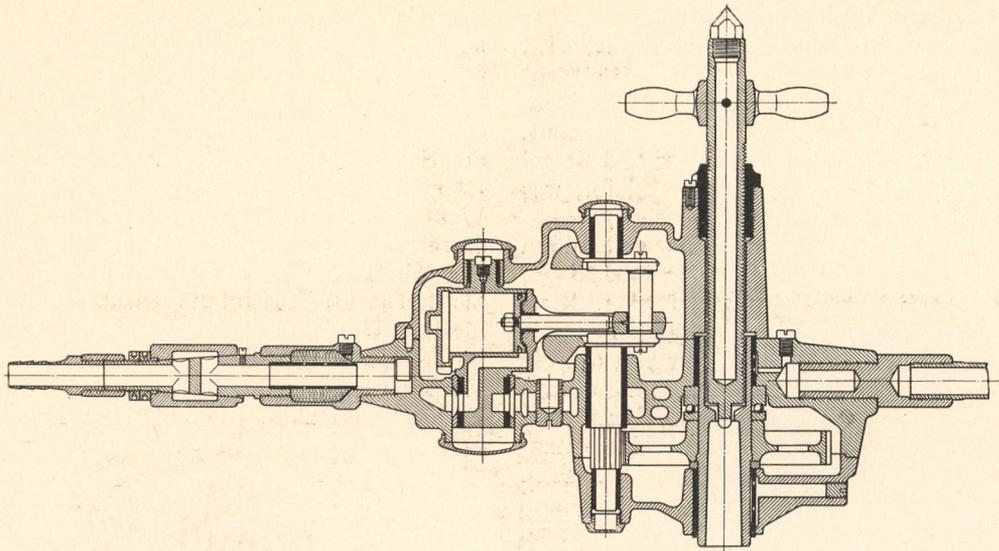
Fig. 479. Transportable Preßluftbohrmaschine. Bauart: W. Kühn.
