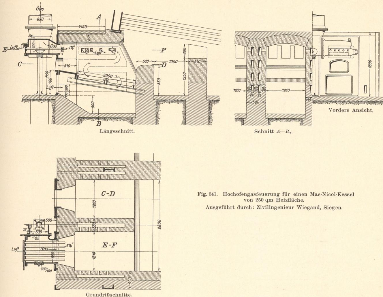
Fig. 341. Hochofengasfeuerung für einen Mac-Nicol-Kessel von 250 qm Heizfläche.
