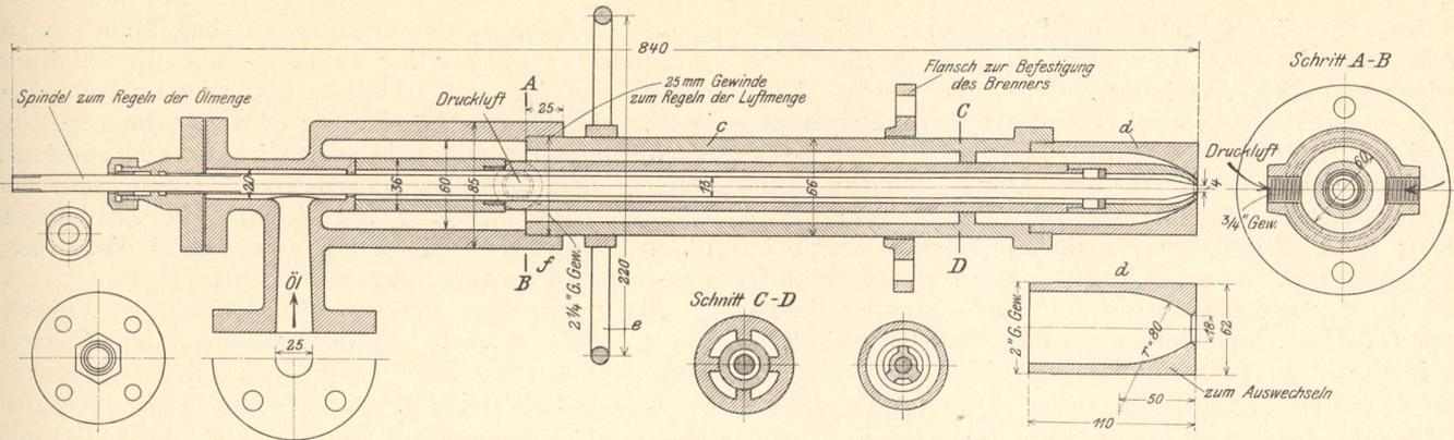
Fig. 335. Düse für Ölfeuerung mit Druckluftzerstäubung.
