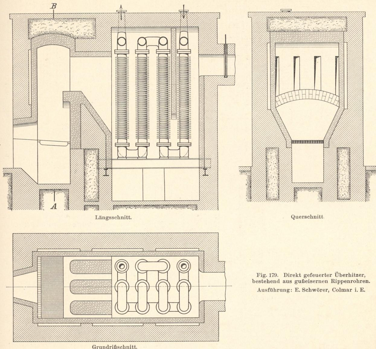
Fig. 179. Direkt gefeuerter Überhitzer,
