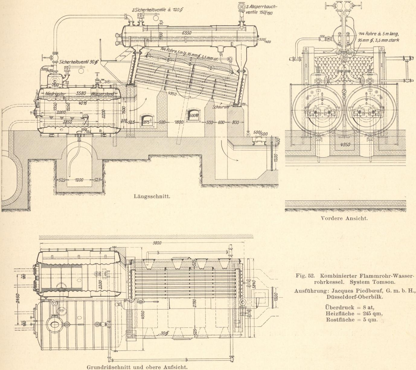
Fig. 52. Kombierter Flammrohr-Wasserrohrkessel. System Tomson.
