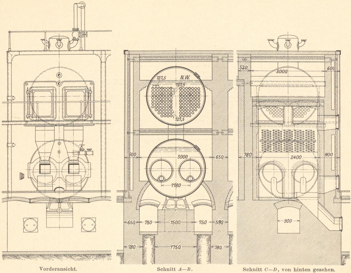
Fig. 46. Kombiniertes Zweiflammrohr-Rauchrohrkessel mit einem Wasserraum und getrennten Dampfäumen.
