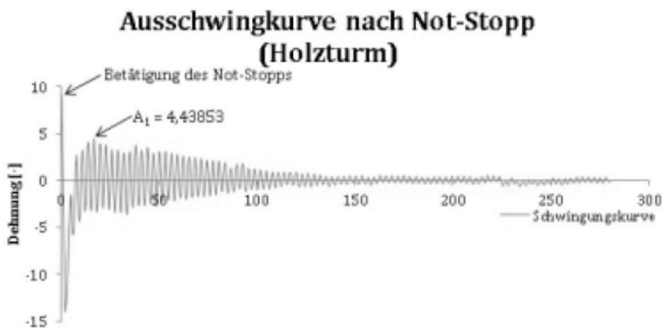
Abbildung 3-13: Ausschwingverhalten eines Holzturmes (Anhand des TimberTowers) [55]
