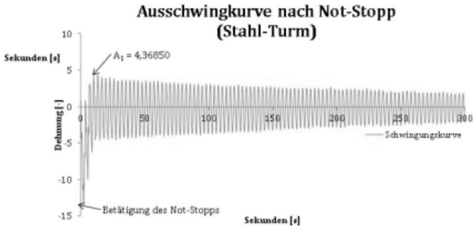
Abbildung 3-12: Schwingungsverhalten eines Stahlturmes [55]
