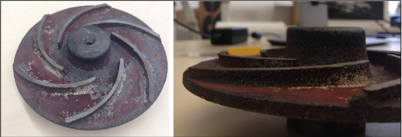
**Abbildung 39: Stufenlaufrad – unbearbeitetes Gussbauteil mit abgedrehter Deckscheibe**
