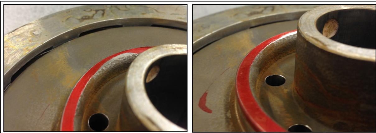
**Abbildung 135: Axiale Zuordnung Laufrad/Leitrad mit Leitschaufelring**
