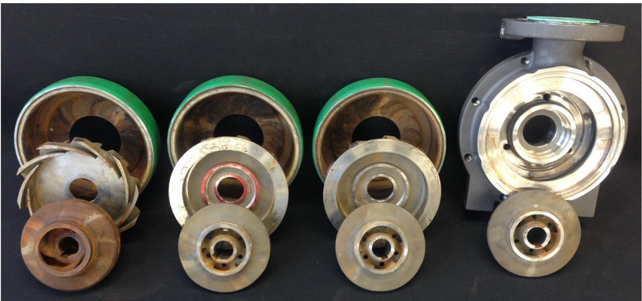
**Abbildung 138: Übersicht der Bauteile der optimierten Variante (ohne Sauggehäuse, Welle und SRM)**
