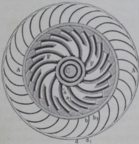
Fig. 283 zeigt. Erstere kommt natürlich bei kleinem und letztere bei großem Gefälle in Anwendung. Im Wesentlichen besteht das eigentliche Rad *AA* aus zwei horizontalen Kränzen von Eisen, aus einem gußeisernen Teller *BB* und aus einer stehenden Welle *CD*. Das bei *W* zufließende Wasser tritt zunächst in das cylindrische Reservoir *EE*. Damit es nicht auf den
