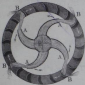
beide Räder nach entgegengesetzten Richtungen umlaufen, so sind sie durch ein besonderes Räderwerk mit einander zu verbinden. Da das größere Rad hierbei vermöge seiner Masse nach Art eines Schwungrades wirkt, so wird hierdurch ein gleichförmigerer Gang erzielt.
