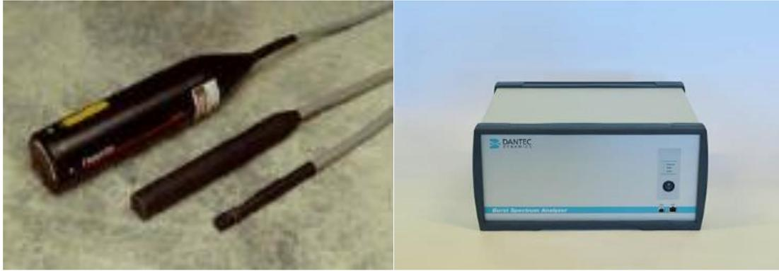
Abbildung 8-8: LDA Laserköpfe [26] und Spektral Analysator [27]
