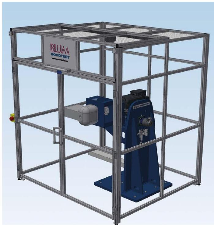
Abbildung 1-14: Novotest – Schwenkprüfstand [4]
