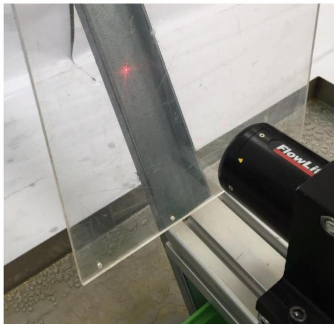
Abbildung 9-8: LDA Sichtfenstertest
