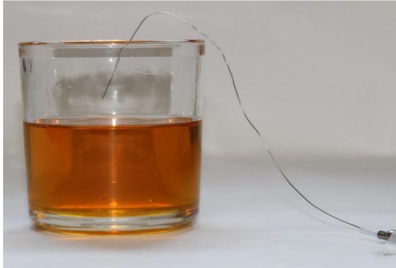
Abbildung 9-5: Thermoelement, Messung Oberfläche
