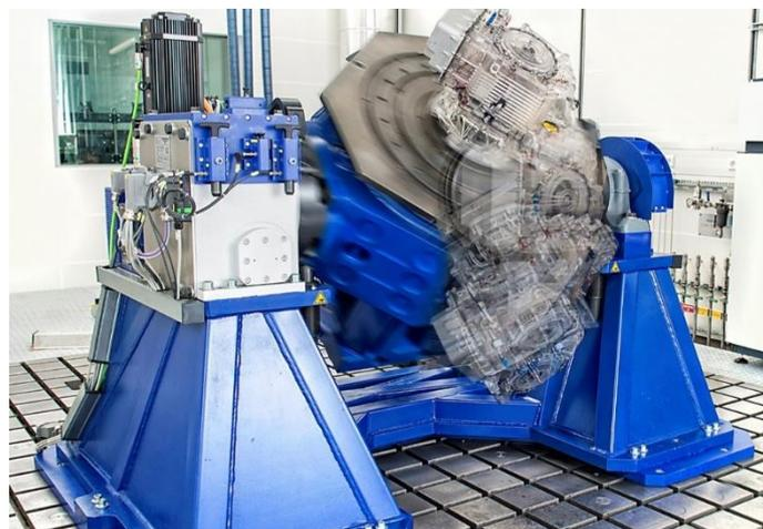
Abbildung 1-15: Schwenkuntersuchung mit Transparentgetriebe [5]
