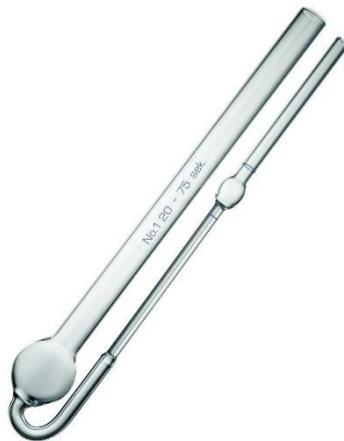
Abbildung 2-3: Kapillarviskosimeter [7]
