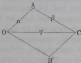
Fig. 22 von  $O$  aus die Stücke  $OA$  proportional  $\alpha$  und  $OB'$  proportional  $\beta$  auf, die Diagonale  $OC$  des aus  $OA$  und  $OB'$  construirten Parallelogramms giebt dann die Richtung der Axe der resultirenden Drehung an, und die Länge  $OC$  ist dem Drehungswinkel  $\gamma$  der resultirenden Drehung nach demselben Verhältnisse proportional, nach welchem  $OA$  und  $OB'$  mit  $\alpha$  und beziehungs-
