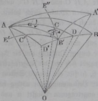
Zu dem Zwecke denke man sich um  $O$  als Mittelpunkt fest im absoluten Raume eine Kugelfläche von dem Halbmesser gleich der Einheit gelegt, welche von den Axen  $OA$  und  $OB$  in  $A$  resp.  $B$  getroffen werde. Empfängt nun der Körper eine Drehung um die Axe  $OA$  im Betrage  $\alpha = B(OA)B'$ , so gelangt dadurch die Gerade  $OB$  des Körpers, welche als nachherige Drehaxe fungiren soll, in die Lage  $OB'$ , welche als ihre Endlage anzusehen ist, da sie bei
