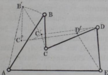
stücke bekannt sind. Anders verhält sich in dieser Hinsicht z. B. die in Fig. 32 skizzierte Verbindung der fünf Cylinderpaare  $ABCDE$ , denn wenn man hier dem Gliede  $AB$  gegen  $AE$  eine Bewegung erteilt, etwa von  $AB$  nach  $AB'$ , so ist dadurch die Lage von  $C$  und  $D$  noch vollkommen unbestimmt, da die zur Feststellung des Fünfecks  $ABCDE$  gegebenen Be-
