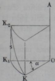
Die Bewegung eines Punktes, vermöge welcher derselbe um eine gewisse Axe in einem bestimmten Gerade gedreht und gleichfalls parallel dieser Axe um ein gewisses Stück verschoben wird, nennt man eine schraubenförmige, und mit Rücksicht hierauf kann man den obigen Satz auch dahin aussprechen, daß jede Ortsveränderung, die ein frei beweglicher Körper erleidet, auch her-
