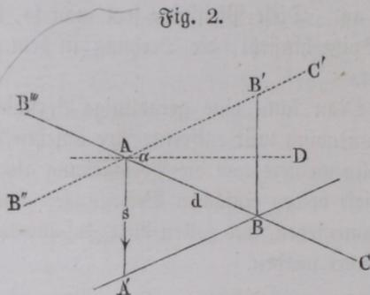
Wenn ein Körper einer Drehung um eine Ase und einer Verschiebung in einer zu dieser Ase senkrechten Richtung unterworfen wird, so lassen sich diese beiden Bewegungen stets zu einer einzigen Drehung zusammensetzen, deren Winkelbetrag gleich dem der gegebenen Drehung ist. Ist nämlich, Fig. 2,  $A$  der Durch-
