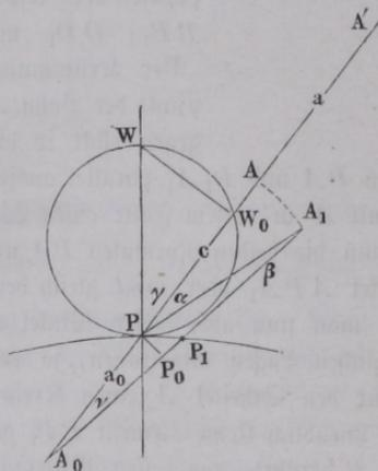
man nun der Kürze wegen den unendlich kleinen Rotationswinkel  $APA_1$  oder  $\omega dt$  mit  $\alpha$ , den Contingenzwinkel  $PA_0P_1$  mit  $\nu$  und den ebenfalls kleinen Winkel  $PA_1P_1$  mit  $\beta$ , so hat man für  $\alpha$  als Außenwinkel die Beziehung  $\alpha = \nu + \beta$ . Um diese Winkel durch die Längen auszudrücken, bestimmt sich zunächst zufolge der Eigenschaft des Wendekreises der Winkel  $\alpha$  als Peripheriewinkel über dem Elemente  $PP_1$ , (s. §. 16) durch
