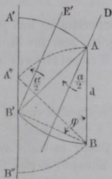
lich klein ist, und es gilt also für den Fall differentialer Bewegungen Aehnliches wie oben für ungleiche Drehungen angeführt worden ist. Der Ausdruck  $2d \sin \frac{\alpha}{2}$  für die Größe der Verschiebung geht für den Fall, daß  $\alpha$  unendlich klein ist, in  $\alpha d$  über.
