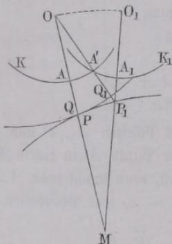
bei berührt diese Curve  $K$  stets eine gewisse Linie  $E$ , welche oben als Enveloppe bezeichnet wurde. Verbindet man den Pol  $P$  mit dem Berührungspunkte  $A$  dieser Enveloppe und der Curve  $K$ , so muß dieser Polstrahl normal auf der gemeinschaftlichen Tangente von  $K$  und  $E$  stehen. Dies geht daraus hervor, daß der Polstrahl auf den Bahnen aller seiner Punkte senkrecht steht, also auch auf der-
