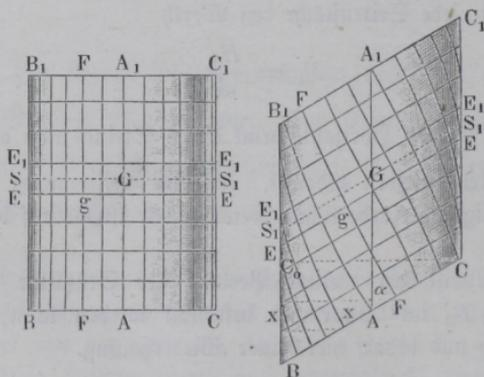
gewölbe, deren Stirnflächen  $BC$  und  $B_1C_1$  in Fig. 101 senkrecht zur Aze, dagegen in Fig. 102 unter einem schiefen Winkel  $A_1AC = \alpha$  gegen die
