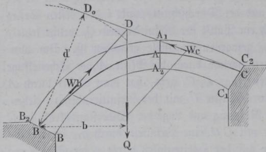
sowie die Tangente der Stützlinie daselbst die horizontale Richtung haben, und auch die Stützlinie zu beiden Seiten symmetrisch ausfallen muß. Wenn dagegen hinsichtlich der Form, oder der Belastungsart oder in Bezug auf beide Elemente zu beiden Seiten des Scheitels eine Verschiedenheit vorhanden ist, so wird auch die Stützlinie
