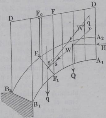
welche die Durchschnittspunkte  $s$  enthält, in denen diese verticalen Trennungsebenen von den bezüglichen Mittelkräften  $W$  getroffen werden. Diese Mittelkräfte selbst hat man sich wieder aus der Zusammensetzung des horizontalen Scheiteldruckes  $H$  mit dem Gewichte  $Q$  des Gewölbtheiles entstanden zu denken, der zwischen der betreffenden Theilungsebene  $FF_1$  und dem Scheitel  $A_1 A_2$  befindlich ist. Die so erhaltene Curve stimmt, streng genommen, nicht mit der dem wirklichen Fugen-
