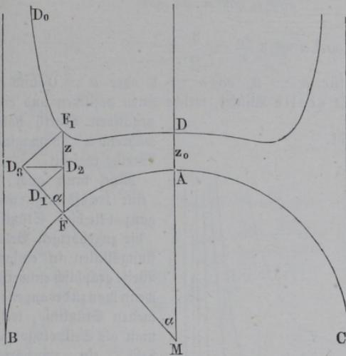
Wenn man entweder in dieser Weise oder durch Rechnung die Belastungslinien für ein und dasselbe Kreisgewölbe vom Radius  $r$ , aber für verschiedene Modul  $a$ , d. h. für verschiedene Scheitelbelastungen
