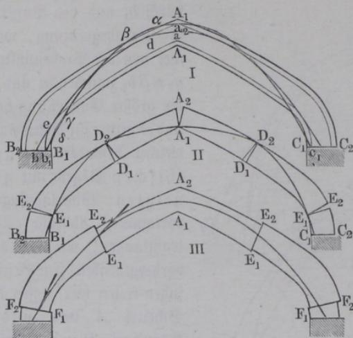
wird die wirkliche sein, sobald sie weder oberhalb  $d$  die innere, noch unterhalb  $e$  die äußere Begrenzung des Kerns durchsetzt. Im Uebrigen gelten ähnliche Betrachtungen, wie in den früheren Fällen, und man erkennt, daß die Bruchfugen, Fig. II bei  $A$ ,  $D$  und  $E$  liegen, während bei einem etwaigen Gleiten in jedem Schenkel das Stück  $EF$  Fig. III, nach außen gedrückt wird. Der hier vorliegende Fall kommt
