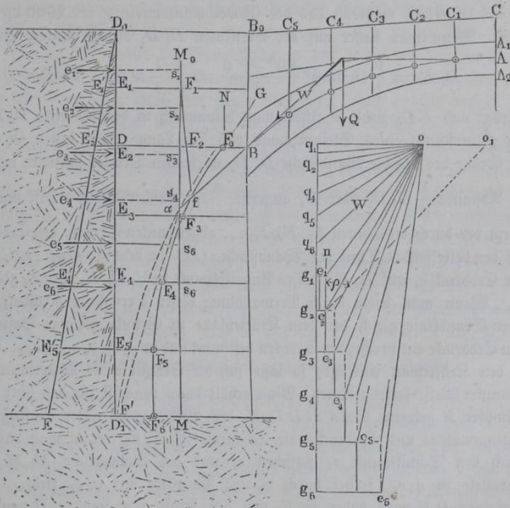
durch  $C_1 C_2 \dots C_5$  die durch  $A$  und  $B$  gehende Stützlinie construirt. Für diese Stützlinie erhält man durch Construction in der bekannten Weise den Horizontalschub  $H$  in der Strecke  $oq$ , und daher ist die resultirende Kraft
