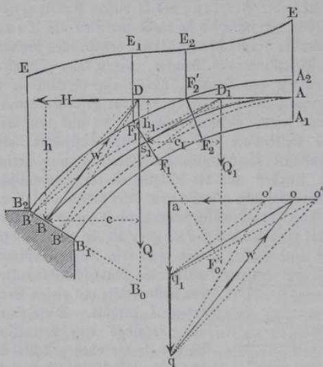
find, oder sobald man außer dem Angriffspunkte  $A$  im Scheitel noch den Angriffspunkt in einer zweiten Fuge kennt, sei es in der Kämpferfuge  $B$  oder in irgend einer anderen. Denkt man sich zunächst in der schon oben angedeuteten Weise alle auf das Gewölbe wirkenden Belastungen durch Mauerkörper von gleichem spezifischen Gewichte mit dem eigentlichen Gewölbsmaterial dargestellt, und gleichmäßig über die ganze Länge (nach der Axe) des Gewölbes vertheilt, so erhält man im verticalen
