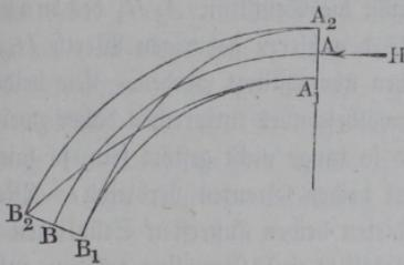
absolut unpreßbarem Materiale bestehenden Gewölbes, welches noch durch das beim Baue erforderliche Lehrgerüst unterstützt ist, so daß angenommen werden muß, daß im Scheitel  $A_1 A_2$  überhaupt noch keine Schubkraft zwischen den beiden Gewölbehälften vorhanden ist. Denkt man sich nun das unterstützende Lehrgerüst weggenommen, so würde die zunächst noch nicht durch eine Horizontalkraft
