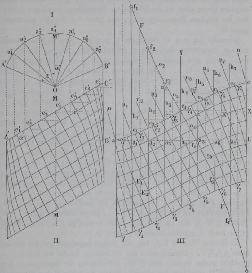
gewölbes, dessen Stirnfläche  $A'C'$  mit dem zur Axe  $MM$  senkrechten Querschnitte  $A'B'$  den Winkel  $\alpha$  bilden möge. Um zunächst die innere cylin-
