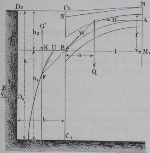
Hinterfüllungs Erde mit einem unter dem Reibungswinkel  $\varrho_1$  gegen den Horizont gerichteten Drucke  $E$  wirken, dessen Angriffspunkt  $D_0$  nach dem vorhergehenden Capitel in  $\frac{h}{3}$  über dem
