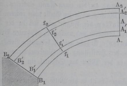
des Materials und aus dem Stützdrucke  $W$ , der sich nach Obigem als Resultirende der Schubkraft  $H$  und des Gewichtes  $G_1$  vom Gewölbestück  $f_1 f_2 A$  ergibt, den Abstand
