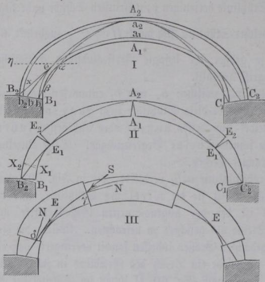
Fall sein würde, so wäre in dem Gewölbe überhaupt keine Stützlinie möglich, und man müßte, um den Einsturz zu verhüten, die Schenkel bei  $B_2$  und  $C_2$  durch eine daselbst aufgeführte Hintermauerung verstärken, so daß die Stützlinie auch dort innerhalb des Kerns verbleibt. Wenn man diese Hintermauerung bis etwa zu der Horizontalen  $\alpha\eta$  durch  $\alpha$  aufführt, so erkennt man leicht, daß der vorliegende Fall auf den
