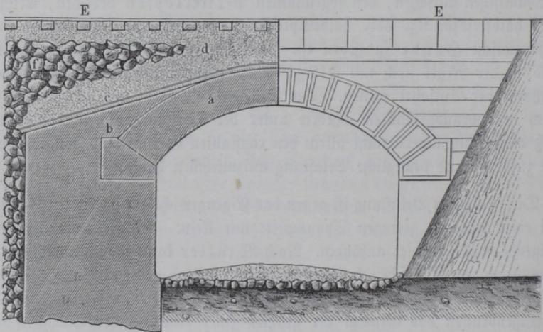
schicht *c* abgedeckt ist. Zum Schutze der letzteren dient zunächst die Kiesschicht *d*, auf welcher die Steinpackung *f* ruht. Die Breite der Brücke beträgt, der zweigeleisigen Eisenbahn *EE* entsprechend, 8,1 m.
