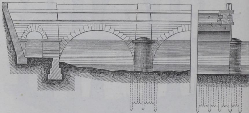
Theil im Querschnitte gezeichnet. Die Länge der Brücke zwischen den Widerlagern beträgt 157,7 m. Von den vorhandenen 12 halbkreisförmig überwölbten Oeffnungen haben die 10 mittleren je 13 m und die beiden äußeren je 3 m. Das aus Quadern 1 m stark ausgeführte Gewölbe a trägt auf einer mit Asphalt überzogenen Betonschicht b das Canalbett c von 2 m Tiefe, 6,5 m oberer und 6 m unterer lichter Weite.
