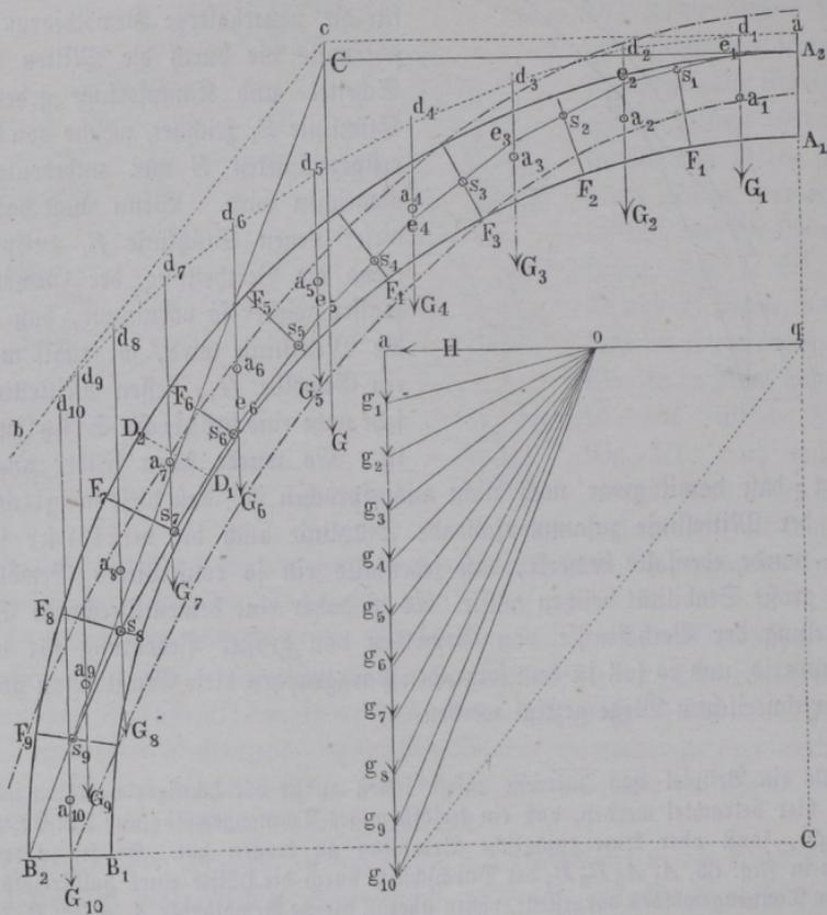
an und construirt mit Hülfe desselben in bekannter Weise ein Seilpolygon  $ad_1d_2d_3 \dots d_{10}b$ , so erhält man in dem Durchschnittspunkte  $c$  der beiden Endstrahlen  $ad_1$  und  $bd_{10}$  einen Punkt, durch welchen die verticale Schwerkraft  $G$  der Gewölbehälfte hindurchgeht. Wenn man nun zwei Punkte für eine Stütze-
