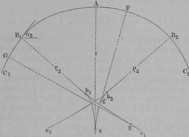
Mittelpunkt in der Spitze  $a$  der Evolute liegt, wandert bei allmählicher Zunahme von  $\alpha$  der Krümmungsmittelpunkt von  $a$  nach  $b_1$  bezw.  $b_2$ , und erreicht diese Ecken, sobald in  $B$  der Winkel der Stützlinie gegen den Horizont nach (19) den Werth  $\alpha_2 = \text{arc tang } \sqrt{\frac{a-3}{2a}}$  erlangt hat, in
