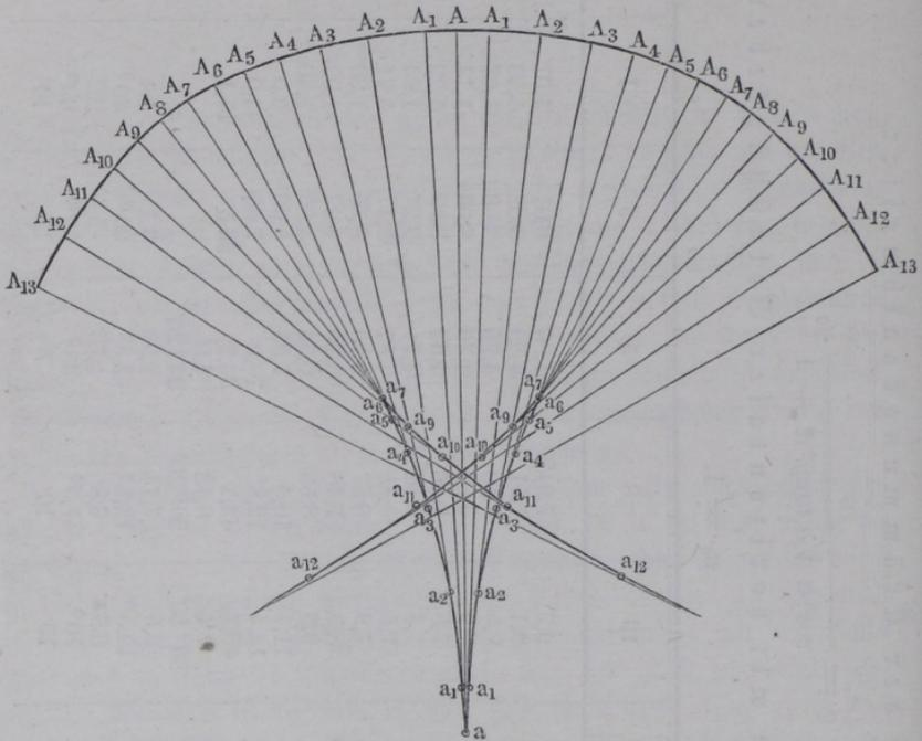
und Mittelpunkte so gewählt werden, daß die einzelnen Bögen nicht nur wie bei den bekannten Korbbögen ohne Knick in einander übergehen, sondern sich auch in ihrem Verlaufe der exacten Stützlinie möglichst nahe anschließen. Zur Bestimmung der geeignetsten Halbmesser für diese einzelnen Kreisbogensegmente giebt Schwedler folgenden Weg an.
