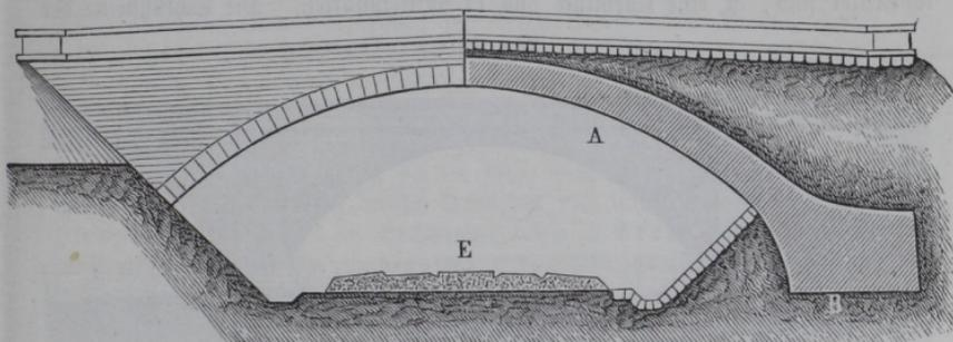
In Fig. 109 ist das Mittelstück der Gölkyschthalbrücke abgebildet. Die Länge dieser Brücke beträgt 574 m, die obere Breite 10 m und die untere 22,6 m, die Höhe von der Bachsohle bis zur Schienenoberkante 77,6 m. Von den mittleren großen Bögen hat *A* eine Spannweite von 28,6 m und eine Höhe von 16,2 m, *B* aber eine Spannweite von 30,8 m und eine Höhe von 19,8 m.
