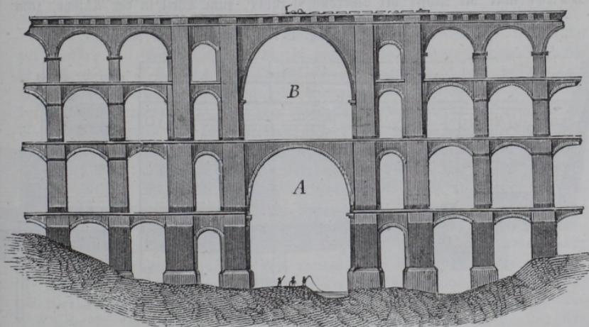
Nimmt man die Höhe eines Ziegelpfeilers  $h = 75$  m und das Gewicht eines Cubikmeters Ziegelmauerwerk gleich 1800 kg an, so erhält man den größten Druck dieses Pfeilers pro Quadratcentimeter, abgesehen von der zufälligen Belastung und von der Belastung durch die Gewölbbögen,
