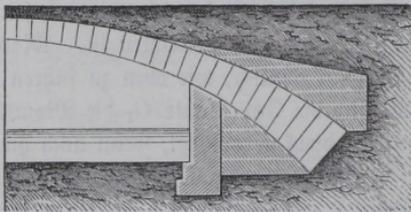
gewissermaßen eine Fortsetzung des Gewölbes bildet. Diese Ausführung wird aber nur in den seltensten Fällen nöthig sein, vielmehr wird auch bei horizontalen Fugen des Widerlagers die gedachte Abweichung der Resultirenden von der Verticalen kleiner sein als der Reibungswinkel  $\varrho$  des Mauerwerks, welchen Winkel man
