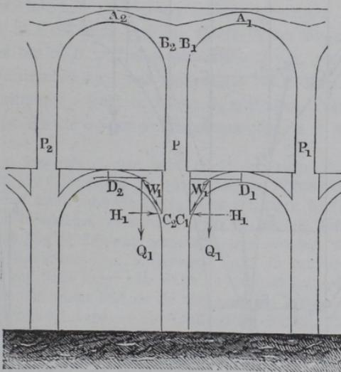
in diesem Falle die Pfeiler mit entsprechenden Oeffnungen in der Höhe der Zwischengewölbe versieht. Je nach der Anzahl solcher Zwischengewölbe unterscheidet man derartige Brücken in ein- zwei- und mehrstöckige. Von der Wirkung einer solchen Verspannung der Pfeiler unter einander kann man sich nach dem Vorhergehenden leicht Rechenschaft geben. Es seien  $P, P_1$  und  $P_2$ , Fig. 91, Zwischenpfeiler eines Viaducts, welche den Bögen
