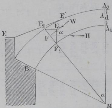
hat, und  $F_1 F_2$  sei irgend eine Gewölbefuge, welche in  $F$  senkrecht zu dem daselbst wirkenden resultirenden Drucke  $W$  angeordnet ist, also mit der Verticalen denselben Winkel  $\alpha = AMF$  bildet, unter welchem die Stützkraft  $W$  gegen den Horizont geneigt ist. Wegen des überall gleichen Horizontalschubes hat man dann
