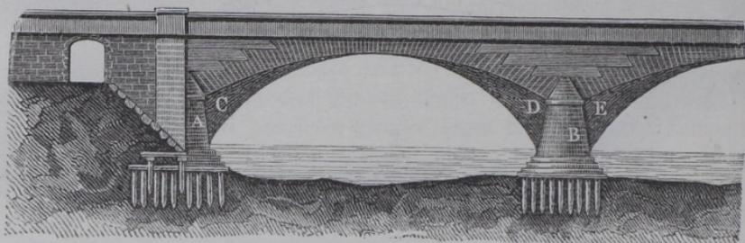
Bögen haben hier eine Stärke von 1,62 m erhalten. Die Pfeilertöpfe (A und B) sind halbkreisförmig abgerundet, und die Kanten zwischen den Stirn- und den inneren Wölbflächen der Bögen sind durch krumme Flächen C, D, E, sogenannte Kuhhörner abgestumpft.
