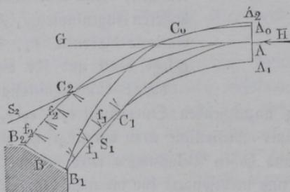
beginnende Stützlilie  $AS_1$  die innere Leibung bei  $C_1$  schneiden, so müßte das zwischen  $C_1$  und  $A$  befindliche Gewölbstück nicht nur um die Kante  $C_1$  eine Rechtsdrehung annehmen und herabfallen, sondern es würden auch alle zwischen  $C_1$  und dem Widerlager  $B$  befindlichen Gewölbtheile herabstürzen, indem die
