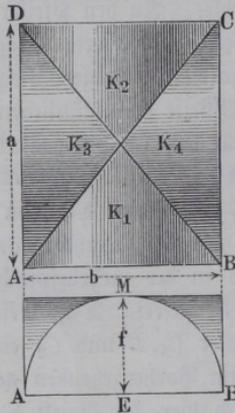
gedacht werden können, daß man eine horizontale, mit  $AB$  parallele Erzeugungsgerade so bewegt, daß sie mit jeder der beiden elliptischen Schnittlinien  $AC$  und  $BD$  einen Punkt gemein hat und dabei stets mit  $AB$  parallel bleibt. Auf diese Weise entsteht über dem Raume  $AC$  eine Decke, die durch zwei sich rechtwinkelig durchschneidende horizontale Tonnengewölbe gebildet
