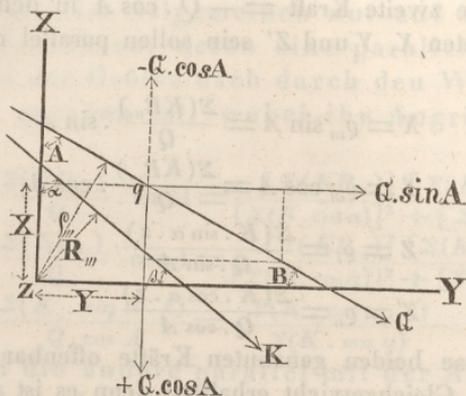
Es sei die Ebene des Papiers die dritte Projektionsebene, also parallel mit den Ebenen, in welchen die Kräfte liegen, die Axe Z normal zur Ebene des Papiers, dann liegen die Axen X und Y in der Ebene des Papiers, nun ist  $q_{III}$  der Abstand der Projektion der Resultirenden auf die Ebene XY und durch die dritte Gleichung zu bestimmen, nämlich:
