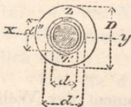
fenbar der, wo die Nabe nur durch die Reibung, die aus dem Druck der Keile entspringt, auf der Welle befestigt ist. Ist  $p$  der Druck, welchen der Keil radial zur Nabe in dem Punkte  $z$  ausübt, so wird auch der entgegengesetzte Punkt  $z'$  mit diesem Druck gegen die Welle geprefst, und der Gesamtdruck, welcher an der Peripherie des Nabensitzes Reibung erzeugt, ist  $2p$ . Wir behalten die vorigen Bezeichnungen bei, und es sei noch
