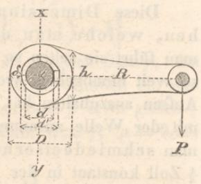
$d$  den auf Torsion berechneten Wellen-Durchmesser,
