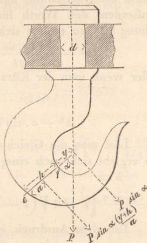
Der Druck  $P$  läÙt sich immer zerlegen in zwei andere, deren einer mit der Richtung  $ef$  zusammenfällt, während der andere normal dazu ist. Dieser letzte Druck  $F \cdot \sin \alpha$  wirkt auf AbreiÙen des Querschnitts  $ef$ , indem er eine Drehung um den entferntesten Punkt des Hakens zu erzeugen strebt, welcher Drehung der Querschnitt des Hakens durch seine absolute Festigkeit widerstehen muÙ. Denken wir den, auf Ab-
