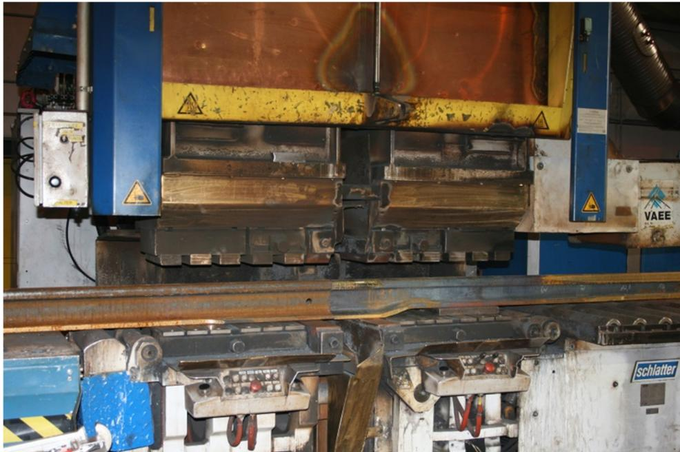
Abbildung 3-8: ABS-Anlage stationär, Fa. Schlatter
