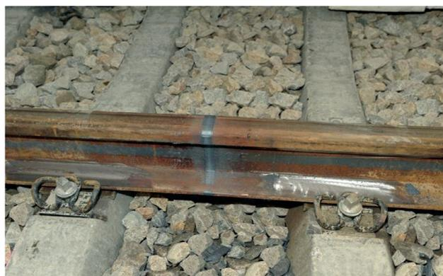
Abbildung 2-1: ABS geschweißte Eisenbahnschiene - Schweißstoß nach Abscheren (2)
