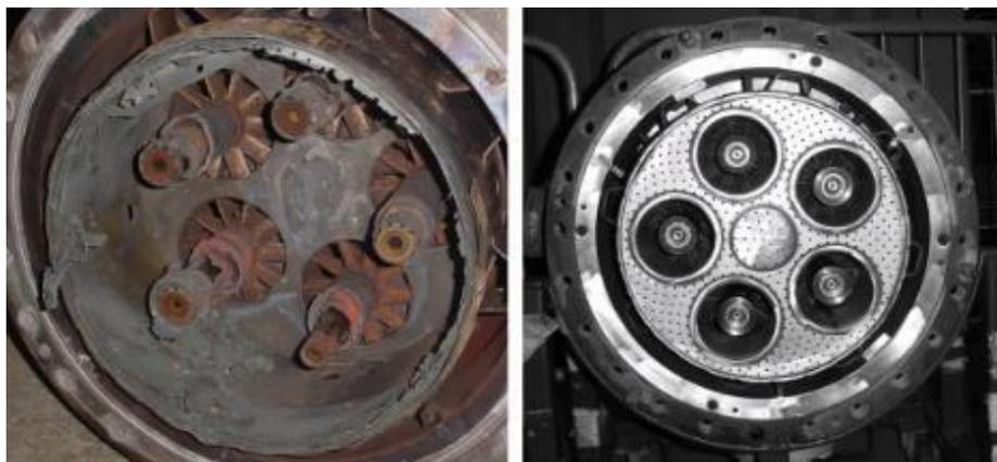
Abbildung 1-4: Schaden infolge thermoakustischer Oszillationen [8].
