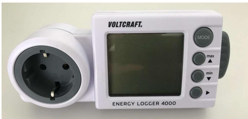
Abbildung 4-5: Voltcraft Energy Logger 4000 zur Messung der Ladeverluste
