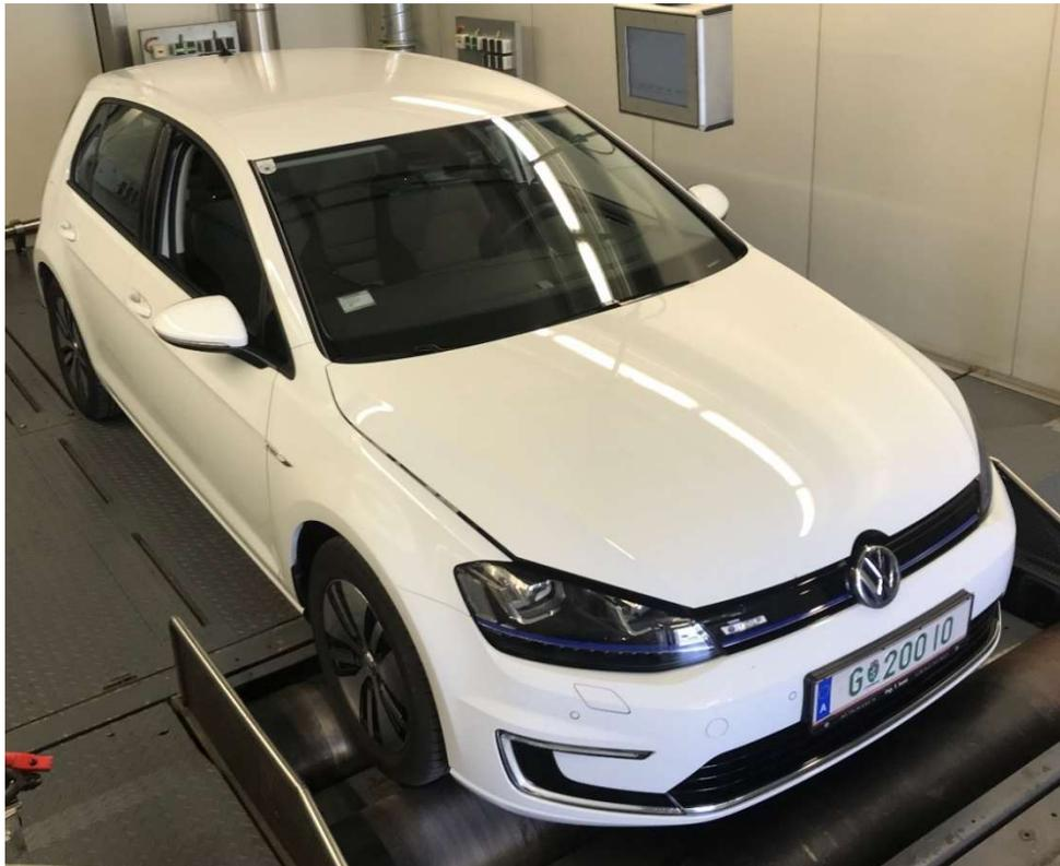
Abbildung 4-10: VW e-Golf am Rollenprüfstand
