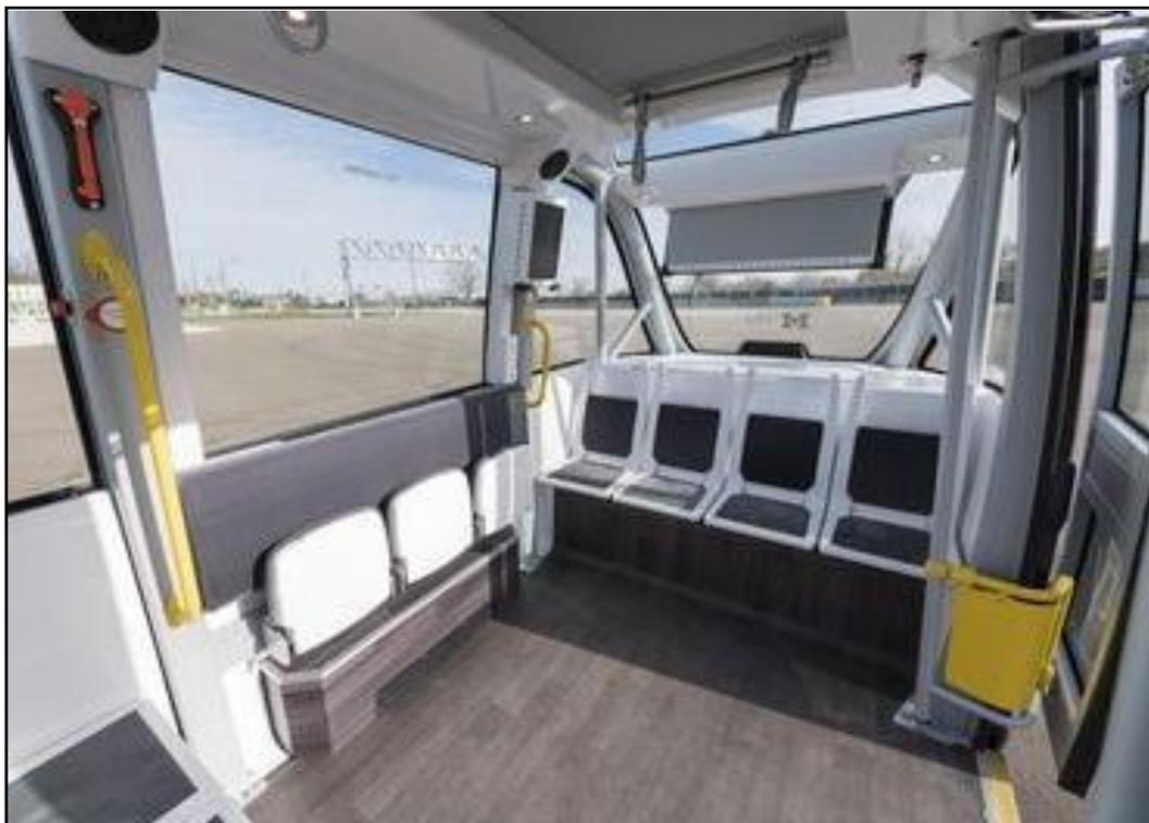
**Abbildung 33: Innenraum eines fahrerlosen bzw. vollautomatisierten Busses**
