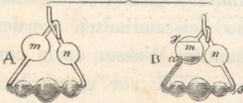
indem man der Luft Zutritt zu dem Roste gestattet, und von oben vermittelst des Windfächers. Sobald die Gasentwicklung schwächer wird, entfernt man das Korkstück und giebt dem Kaliapparate die horizontale Stellung Fig. 40, A.
