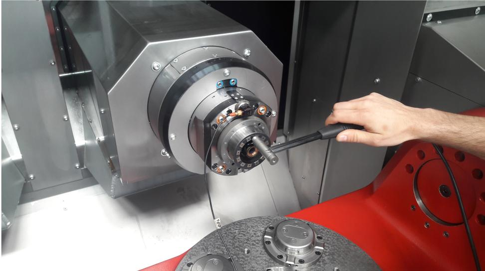
Abbildung 6.4: Achsstellung:  $X = 0$  mm  $Z = 130$  mm , Schlag auf HSK, Schlagrichtung: z
