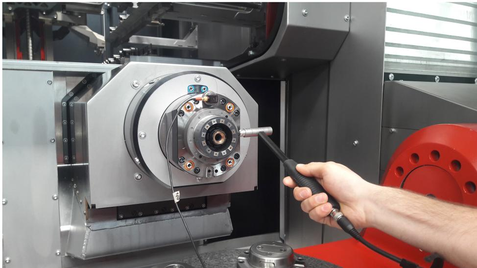
Abbildung 6.2: Achsstellung:  $X = 0 \text{ mm}$   $Z = 130 \text{ mm}$  , Schlag auf HSK, Schlagrichtung: x
