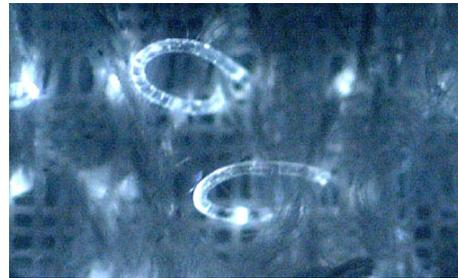
(b) Detail: die Lichtauskopplung erfolgt aufgrund enger Biegeradien. Quelle: [50]
