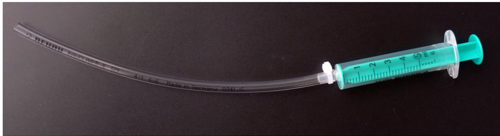
Abbildung 2.24: 4×6 PVC-Schlauch mit Kabelbinder auf einer Injektionsspritze mit Luer Konus fixiert, zur Herstellung von zylindrischen Formen
