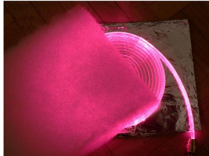
(a) Spiralförmig aufgewickelte, nicht verspiegelte Seitenlichtfaser zwischen einer spiegelnden Hintergrundfolie und einem Streukörper aus Polyestervlies. Äußerer Durchmesser der Spirale: 9,5 cm
