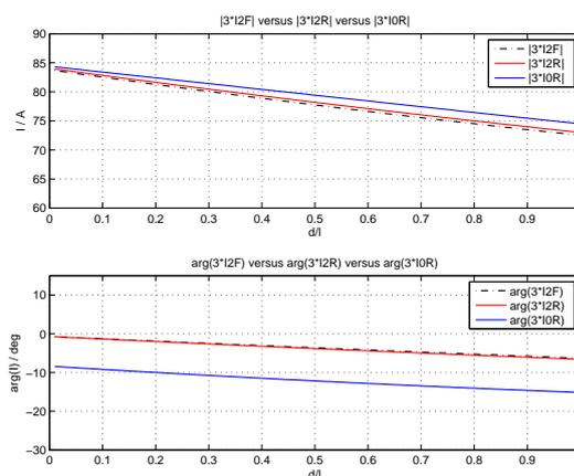
Abbildung 8.8.: Betrag und Winkel der Ströme  $3 \cdot I_F^2$ ,  $3 \cdot I_R^2$  und  $3 \cdot I_R^0$  für KNOSPE mit  $R_{SPE} = 40 \Omega$
