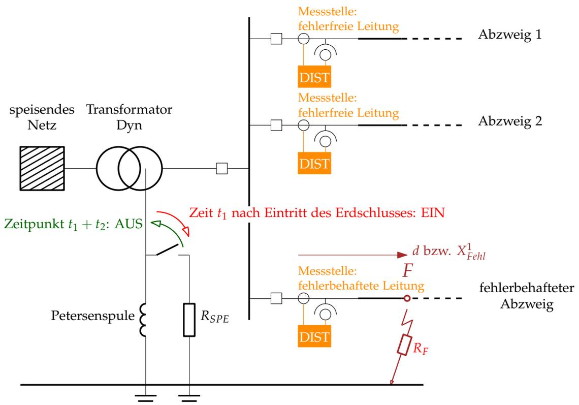
Abbildung 1.1.: Prinzipschaltung für das Verfahren der Erdschluss-Tiefenortung mittels Distanzschutzgeräten
