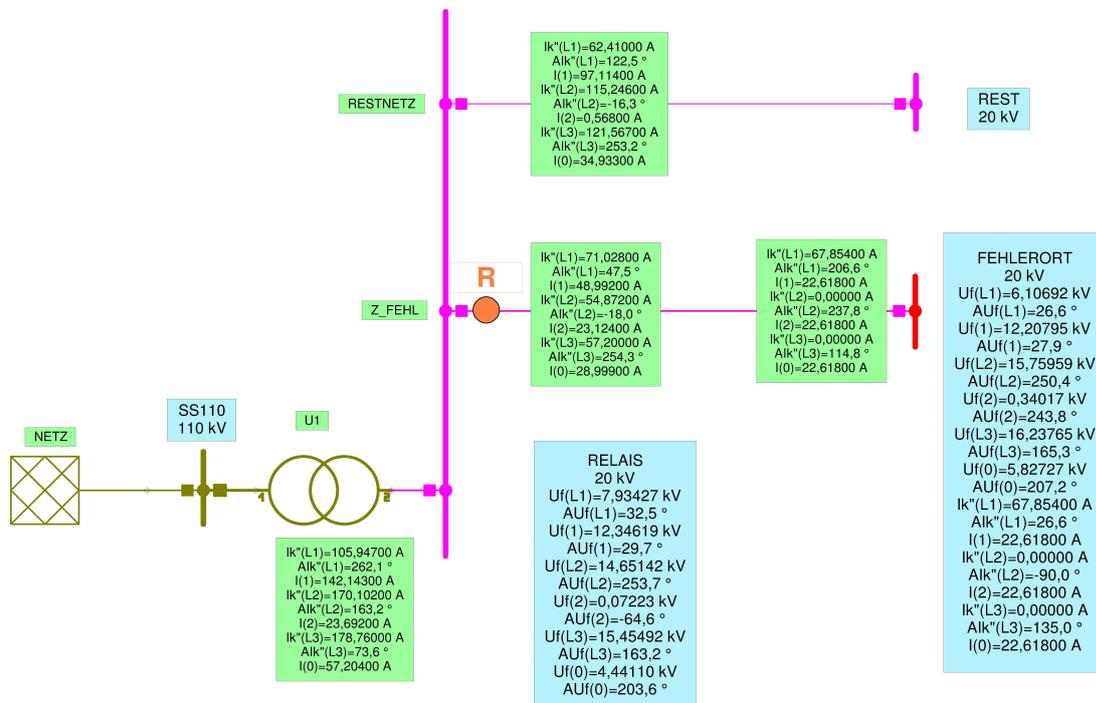
Abbildung 7.4.: Netzberechnung von (7.1) mittels NEPLAN für  $R_F = 90 \Omega$
