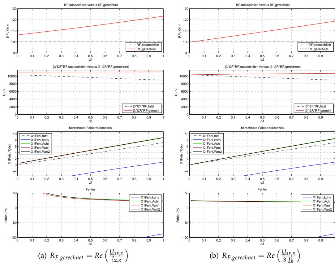
Abbildung 8.5.: Fehlerwiderstand, Korrekturterm, Fehlerentfernung und Fehler für NOSPE mit  $R_{SPE} = 40 \Omega$
