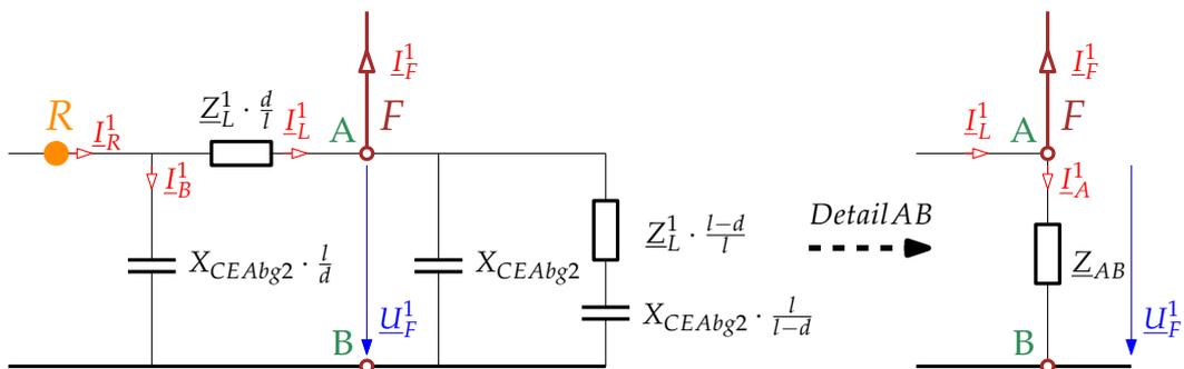
Abbildung 5.5.: Leitungsende-Fehler in einem einfachen Strahlennetz im Originalsystem
