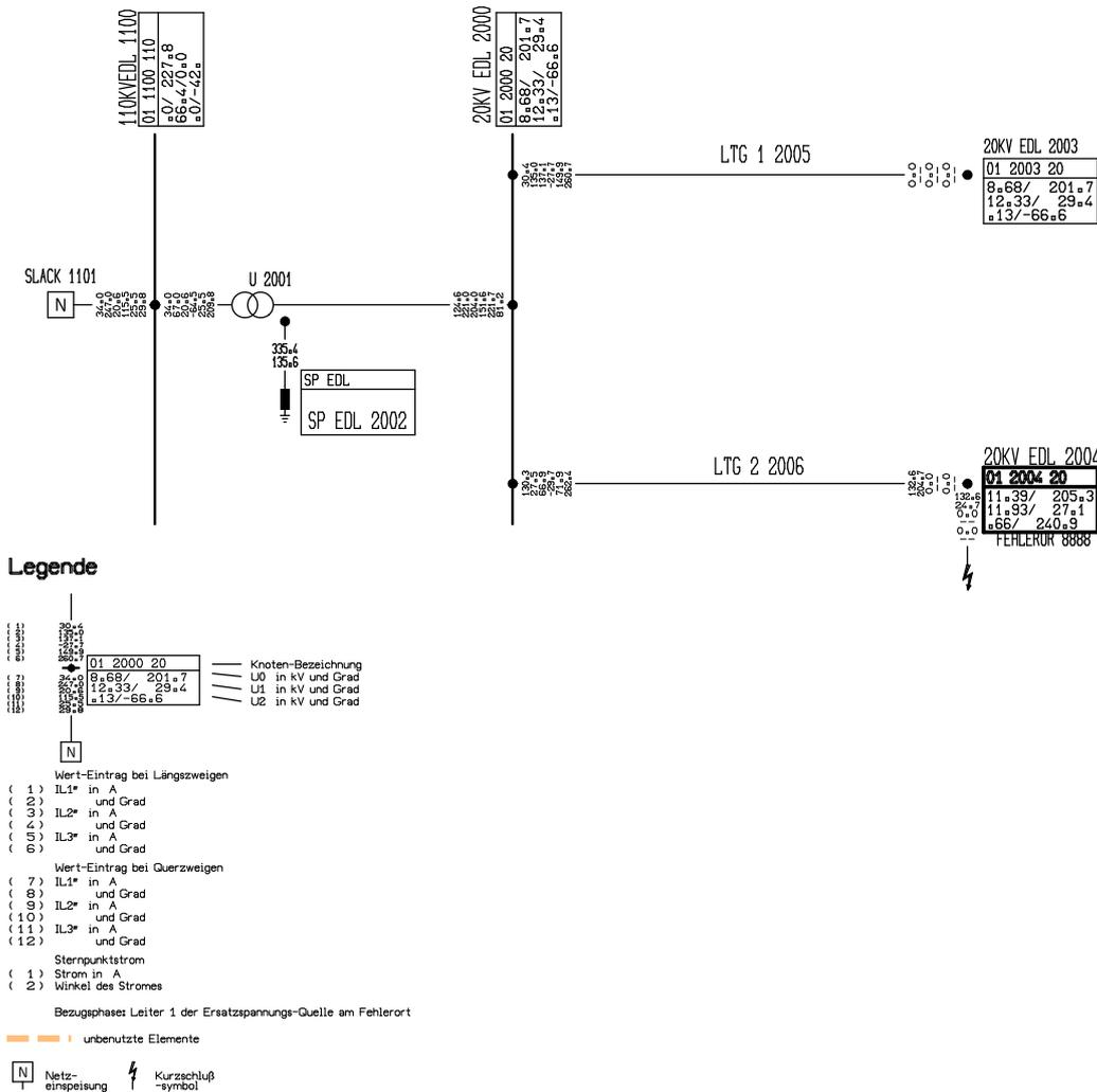
Abbildung 7.3.: Netzberechnung von (7.1) mittels INTEGRAL für  $R_F = 0 \Omega$
