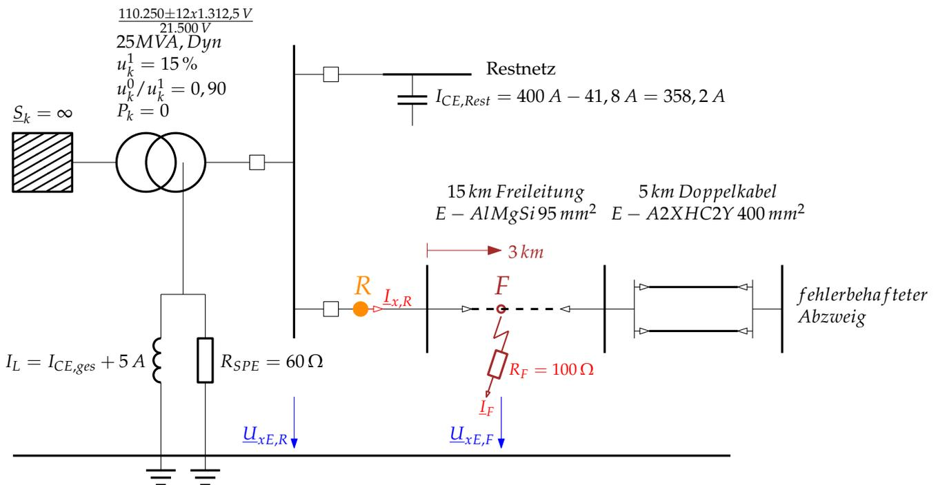
Abbildung 8.14.: Modellnetz für die Fehlerberechnung einer abschnittsweise homogenen Leitung Freileitung – Kabel
