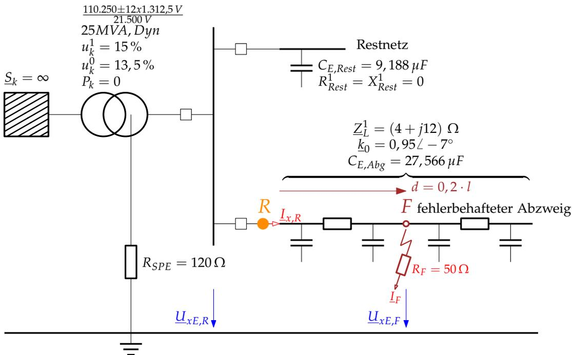
Abbildung 7.8.: 20-kV-Netz für die Berechnung eines Fehlers L1-E im Leitungsverlauf
