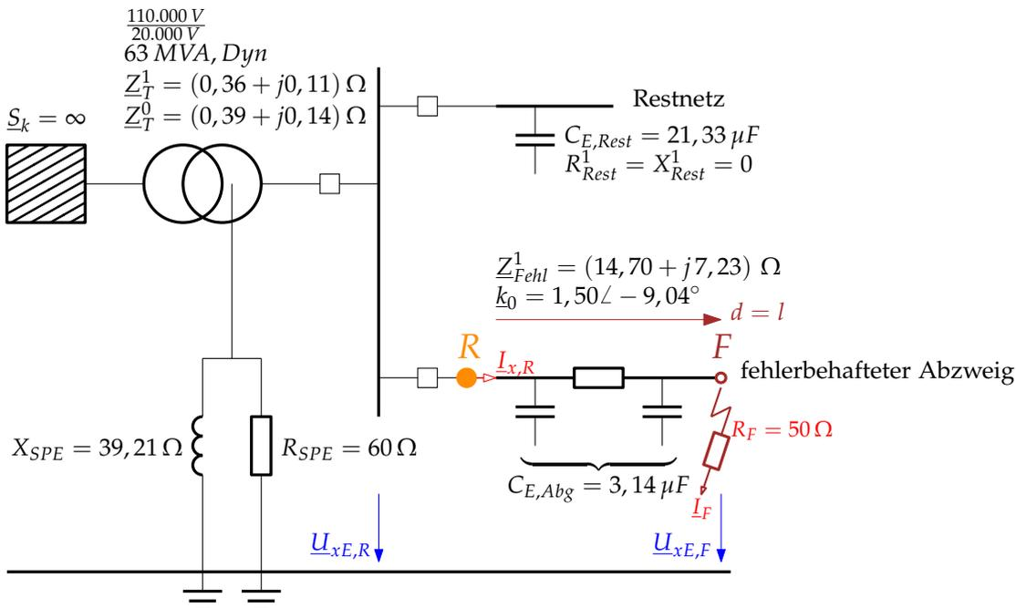
Abbildung 7.10.: 20-kV-Modellnetz für die Simulation eines Leitungsende-Fehlers L1-E
