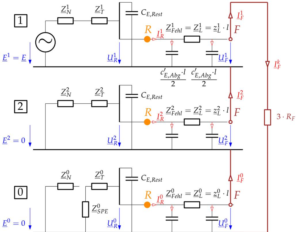
Abbildung 5.2.: Komponenten-Ersatzschaltbild eines Leitungsende-Fehlers in einem einfachen Strahlennetz
