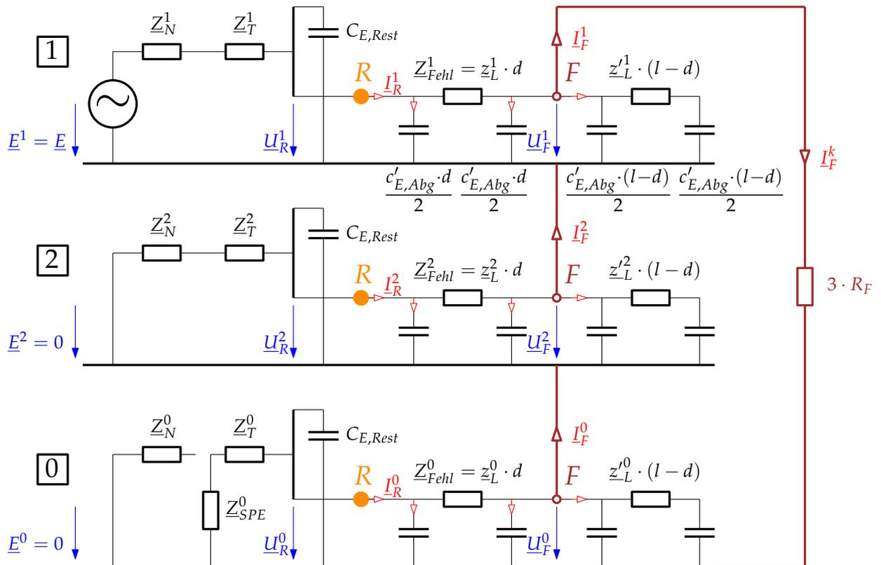
Abbildung 3.2.: Komponenten-Ersatzschaltbild eines einfachen Strahlennetzes
