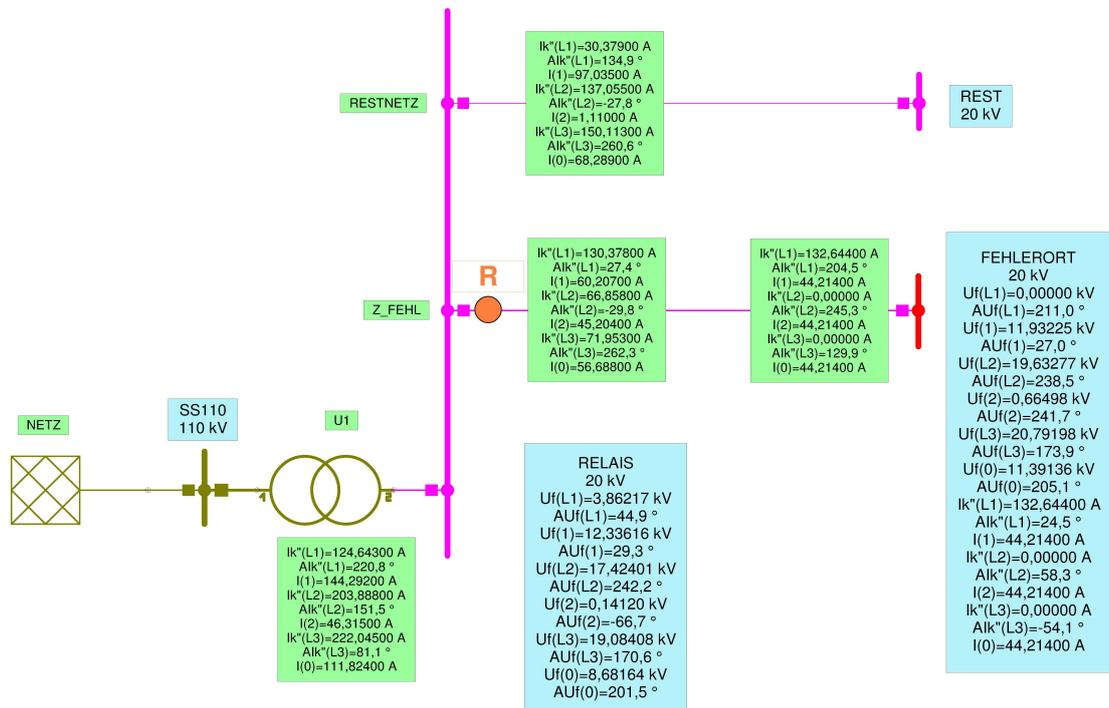
Abbildung 7.2.: Netzberechnung von (7.1) mittels NEPLAN für  $R_F = 0$
