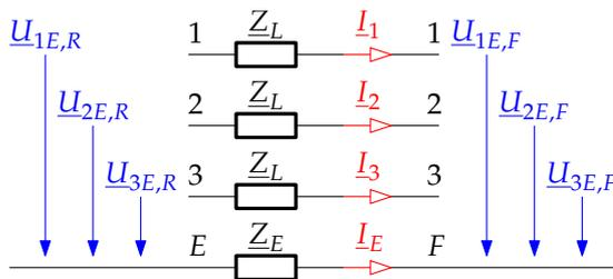
Abbildung 3.4.: Drehstromleitung mit unabhängigen Phasenimpedanzen und Erdrückleitung
