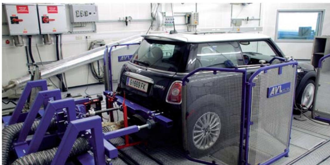
Abbildung 8: Verspanntes Fahrzeug am Rollenprüfstand (Symbolfoto) [14]
