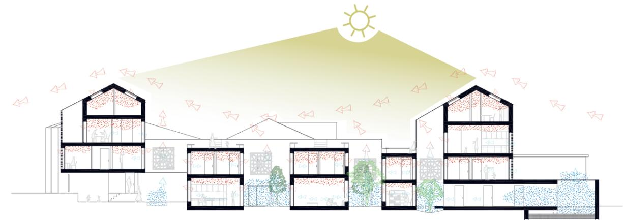
Abb. 130: Schema Luftzirkulation
