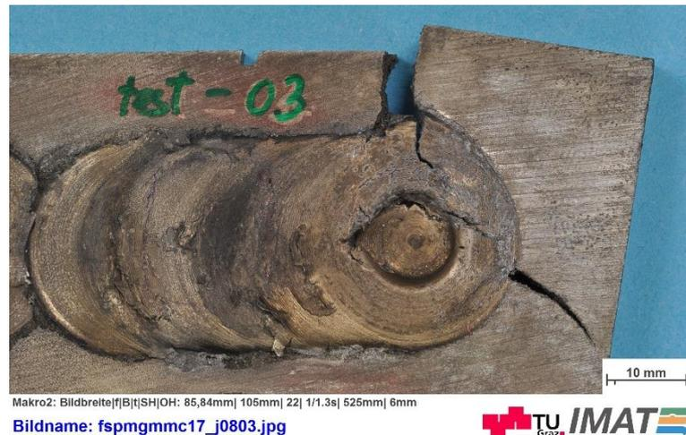
Abbildung 26: FSP test-03 - Bruch des Werkstücks
