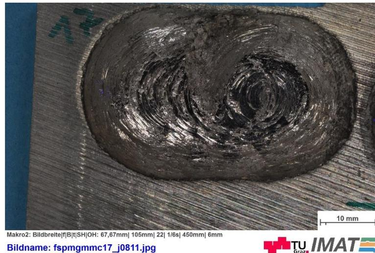
Abbildung 30: Fehler durch ein verklebtes Werkzeug bei test-17 (900rpm, 200mm/min)
