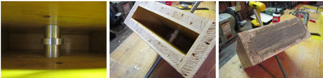
Abbildung 2.9: Test mit einer Hülse aus Aluminium und mittig gefrästem Ring. Die Hülse wird mittels Gewindestange in Position gehalten. Ein Ausbeulen der Schalung wird durch Anbringen von Schraubmuttern auf der Schalungsaußenseite verhindert.
