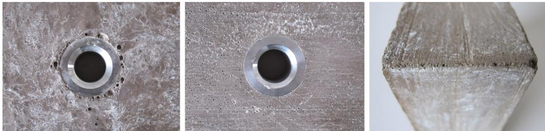
Abbildung 5.7: Detailaufnahmen vom ersten Farbmuster und den eingegossenen Edelstahlhülsen
