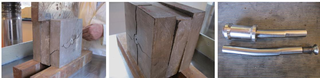
Abbildung 2.12: Beim Abscherversuch blieb der mittlere Prüfkörper unbeschädigt. Die ersten Risse traten bei einer Belastung von 95 kN auf.
