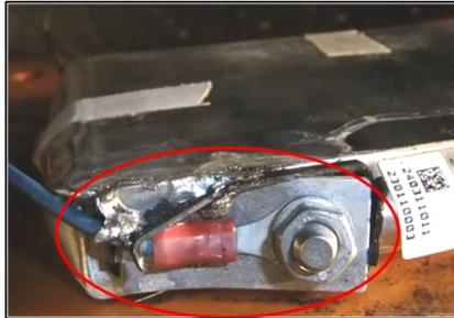
Abbildung 9.4: Äußerer Kurzschluss an der Verbindung von Polplatte und Capplate infolge des Versagens der Verbindung zwischen diesen Komponenten im Zuge der Stauchversuche in y-Richtung
