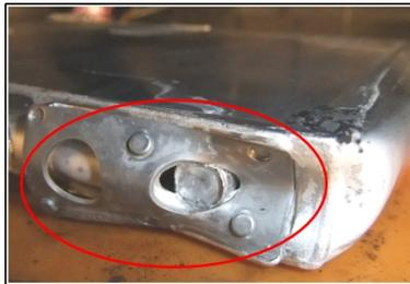
Abbildung 9.3: Versagen der Verbindung zwischen Polplatte und Capplate im Zuge der Stauchversuche in y-Richtung
