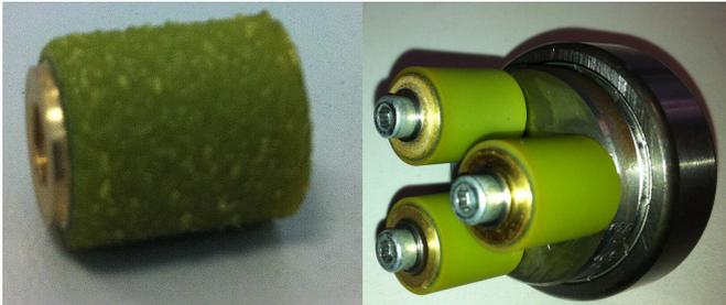
**Abb. 6-5 Sehr raue Planetenoberfläche (links) im Vergleich zur normalen Oberfläche (rechts)**
