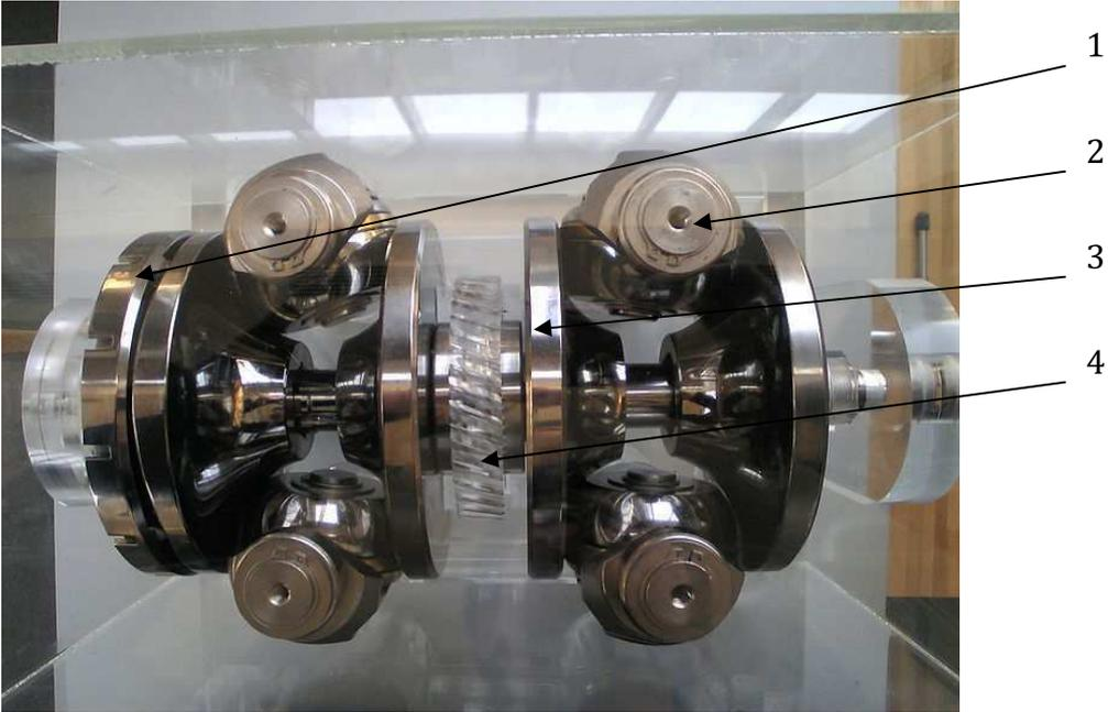
Abb. 2-5 Extroid-CVT-Getriebe von Nissan [8]
