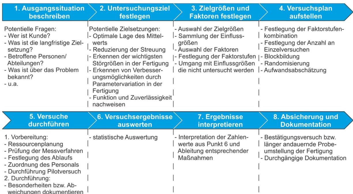
Abbildung 55: Teilschritte eines geplanten Versuchs auf Basis der statistischen Versuchsplanung
