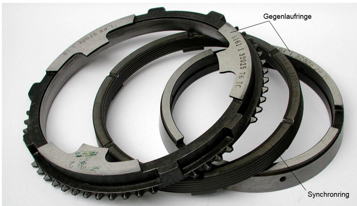
Abbildung 32: Synchronring mit innen- und außenliegenden Reibflächen und Gegenlaufringe als Prüfkörper einer empirischen Verschleißanalyse
