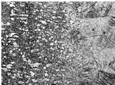
**Abbildung 20: Grundmaterial, WEZ und Schweißgut in einer Verbindungsschweißung von TiAl6V4 [30]**
