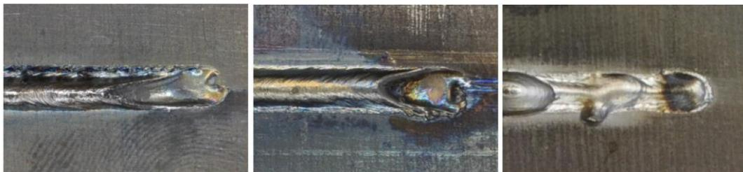
Abbildung 13: (links) Drahthöhe zu tief, (Mitte) Drahthöhe korrekt und (rechts) Drahthöhe zu hoch [8]
