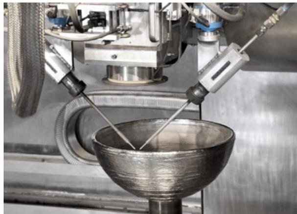
Abbildung 1: Hohle Halbkugel gefertigt von Sciaky Inc. [9]
