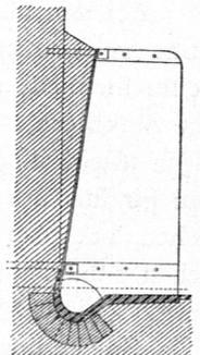
nicht immer kommt der Urin in die Rinne, sondern fließt wohl auch an der Untermauerung, event. an der Piffoir-Rückwand auf den Fußboden und, weil der letztere zum Schutze der Rückwand nach außen geneigt sein muß, auf den davor befindlichen Aufstellungsplatz etc. Es kommen deshalb solche Constructionen gegenwärtig nur bei ganz primitiven Piffoir-Einrichtungen vor; man verlegt vielmehr zur Zeit die Urinrinne fast ausschließlich in eine an die Piffoir-Rückwand anstoßende Vertiefung des Fußbodens.
