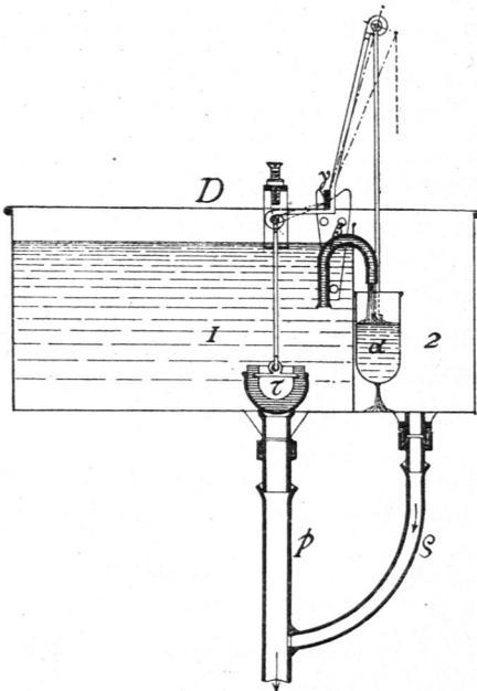
armigen Hebel verbunden, dessen Axe  $\gamma$  auf einer Schneide ruht. Am anderen Arme des Hebels hängt ein Blechgefäss  $\alpha$ , welches unten eine kleine, 4 mm weite Oeffnung hat. Kammer 1 und Gefäss  $\alpha$  sind durch einen Heber  $\beta$  in Verbindung gebracht.
