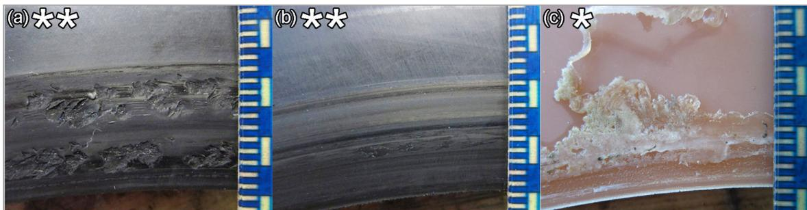
Abbildung 106: Verschleißbilder der Dichtungen ohne Schmiernut und mit konischem Dichtring bei (2,6 bar / 1,7 mm); (a) NBR, (b) EPDM, (c) PUR
