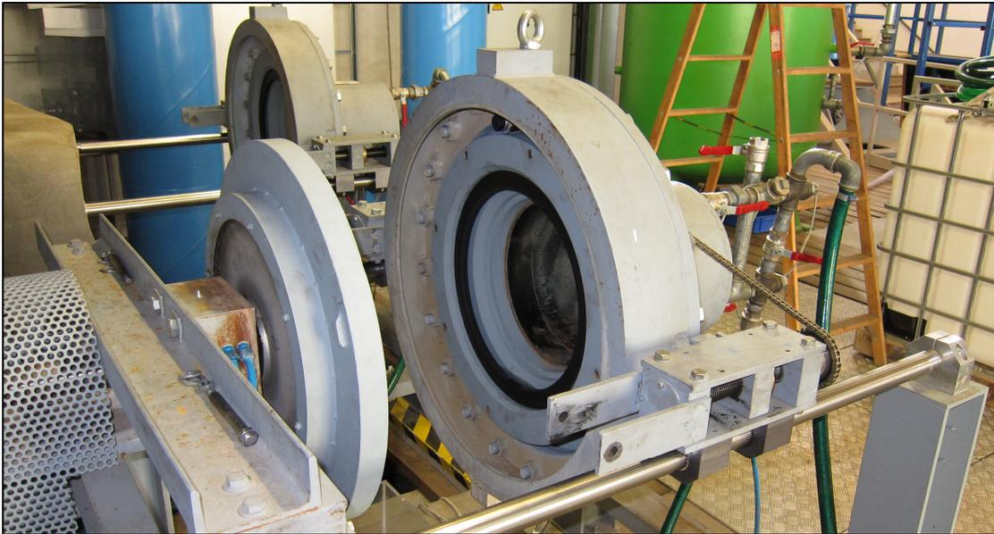
Abbildung 69: Prüftrommel im offenen Zustand mit montierter Dichtung (schwarz)
