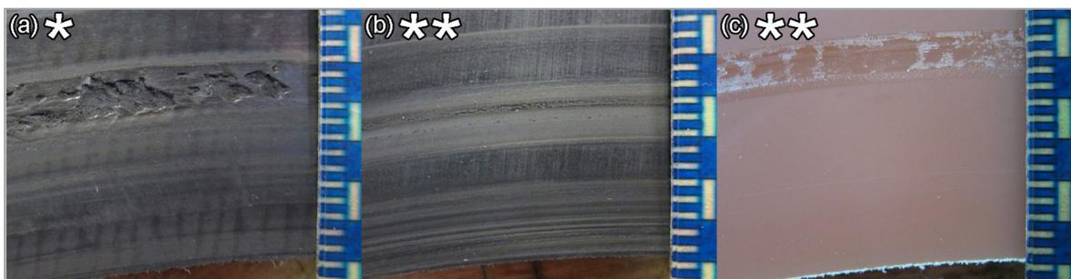
Abbildung 103: Verschleißbilder der Dichtungen ohne Schmiernut bei (2,6 bar / 1,7 mm); (a) NBR, (b) EPDM, (c) PUR
