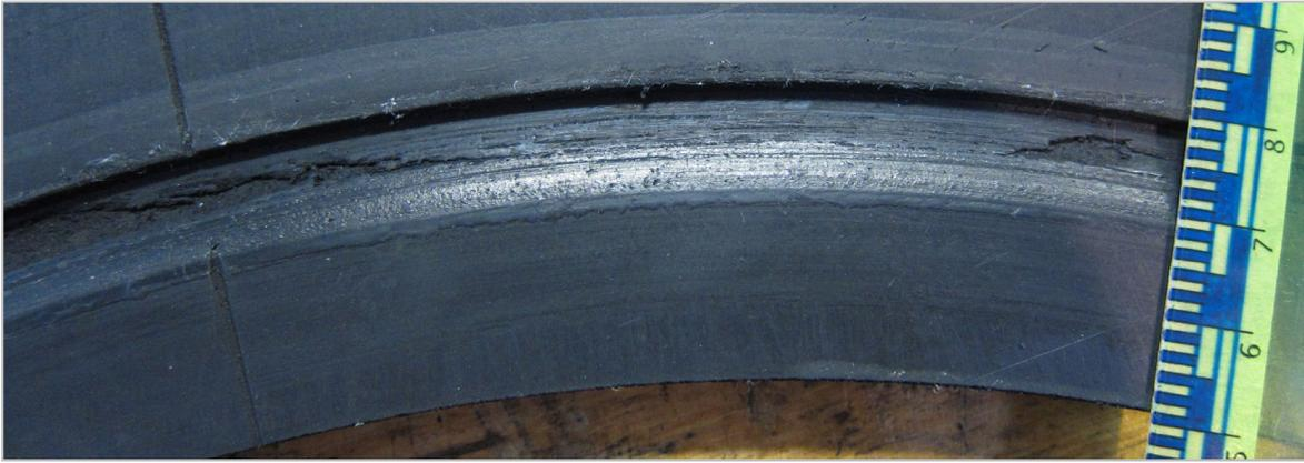
Abbildung 90: Dichtung nach den Folgeversuchen bei (1 bar / 0,5 mm) und (2,6 bar / 1,7 mm sowie 2,5 mm)
