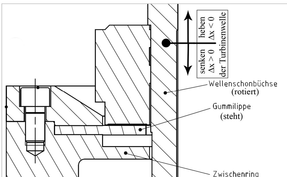
Abbildung 16: Dichtungskonzept KW Wallsee-Mitterkirchen HM6 bis 2013 [Vgl. 11]
