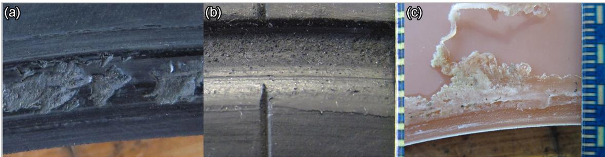
Abbildung 112: (a) Pulverförmiger Verschleiß; (b) tribochemische Oberflächenschicht; (c) Verschleiß durch Schmelzen
