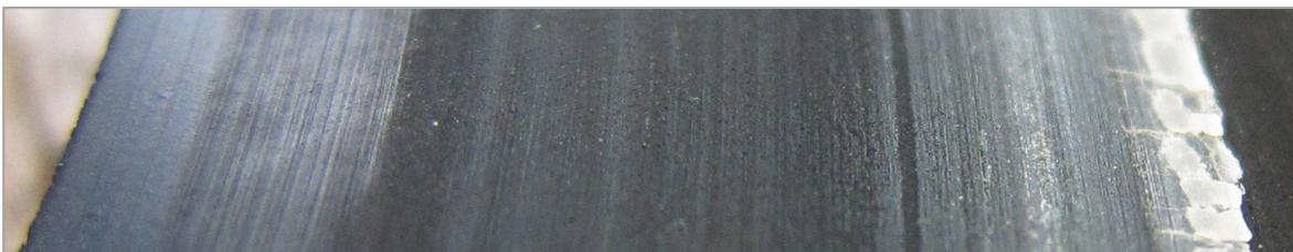
Abbildung 100: Nahaufnahme der Dichtungsfläche nach zweiwöchiger Versuchsdauer bei (2,6 bar / 2,5 mm)
