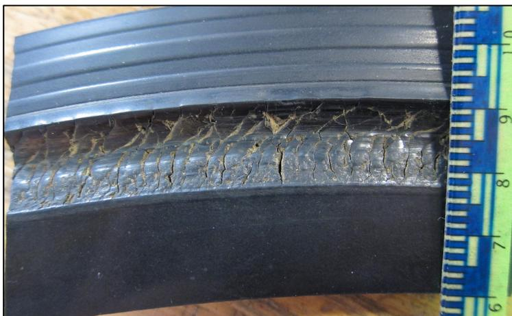
Abbildung 21: Beschädigte Dichtung KW Faching
