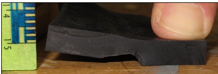
Abbildung 22: Plastische Verformung der beschädigten Dichtung KW Faching
