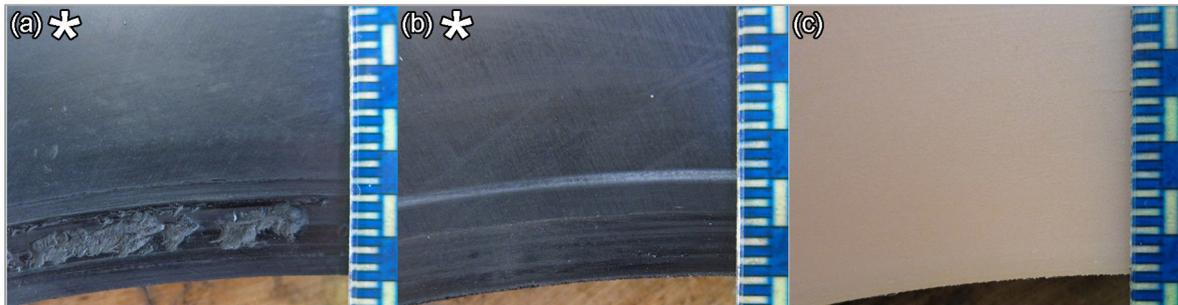
Abbildung 105: Verschleißbilder der Dichtungen ohne Schmiernut und mit konischem Dichtring bei (1 bar / 0,5 mm); (a) NBR, (b) EPDM, (c) PUR
