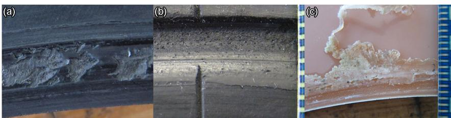
Abbildung 44: Am Prüfstand beobachtete Verschleißformen
