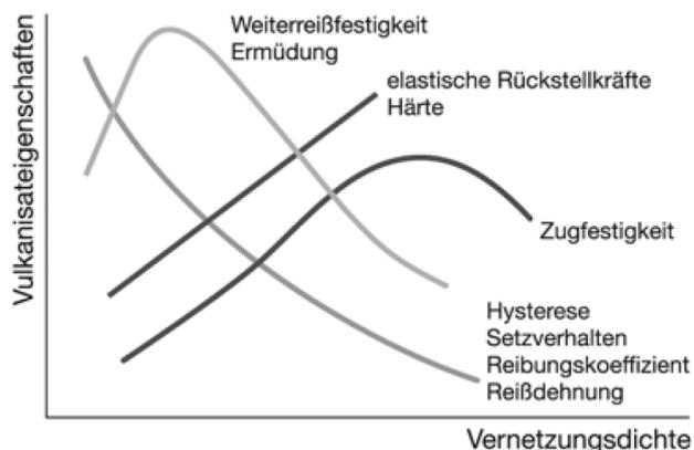
Abbildung 47: Abhängigkeit der mechanischen Eigenschaften von der Vernetzungsdichte [26 S. 1239]
