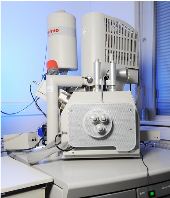
Abb. 2: FEI ESEM Quanta 600 [11], Rasterelektronenmikroskop
