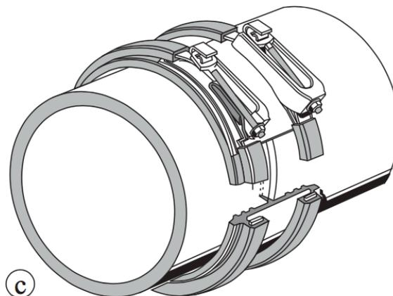
Abbildung 21 Montagekupplung (2)
