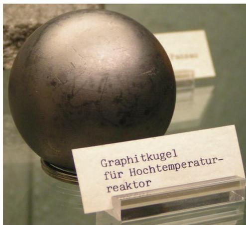
Abbildung 27: Brennstoffkugel für Hochtemperaturreaktor (Analytik ETHZ, 2016)
