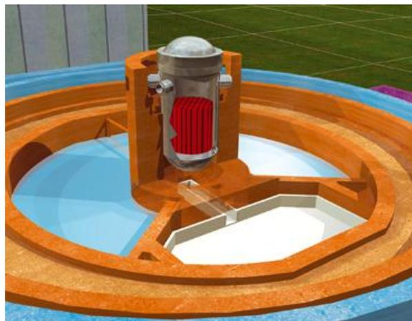
Abbildung 33: Schematische Darstellung des EPR-Konzeptes mit Reaktordruckkessels inklusive Core-Catcher (TVO Core-Catcher, 2016)
