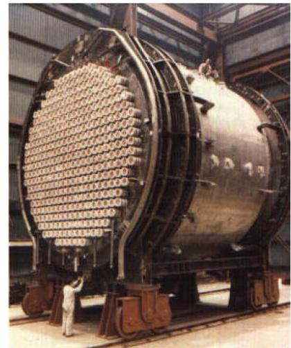
**Abbildung 23: CANDU-Reaktorkern (Analytik ETHZ, 2016)**
