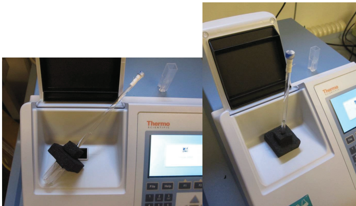
Abbildung 34: OD Messung der Bakteriensuspension im NMR Röhrchen: die Probe im NMR Röhrchen in der speziell angefertigten Küvette mit einer Kappe aus Schaumstoff (links); das NMR Röhrchen im Multiskan Microplate Spectrophotometer (rechts).
