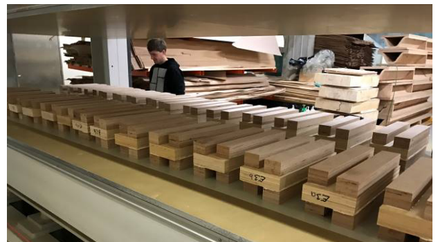
Abb. 2.10 Händischer Klebstoffauftrag mit Zahnpachtel (links) und Einlegen der Probekörper in die Furnierpresse (rechts)
