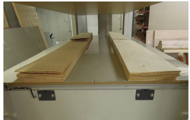
Abb. 2.9 Stapelung der mit Klebstoff benetzten Einzelfurniere (links) und Einlegen von jeweils vier Versuchskörpern in die Furnierpresse (rechts)
