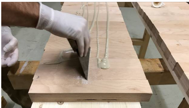
Abb. 2.10 Händischer Klebstoffauftrag mit Zahnpachtel (links) und Einlegen der Probekörper in die Furnierpresse (rechts)
