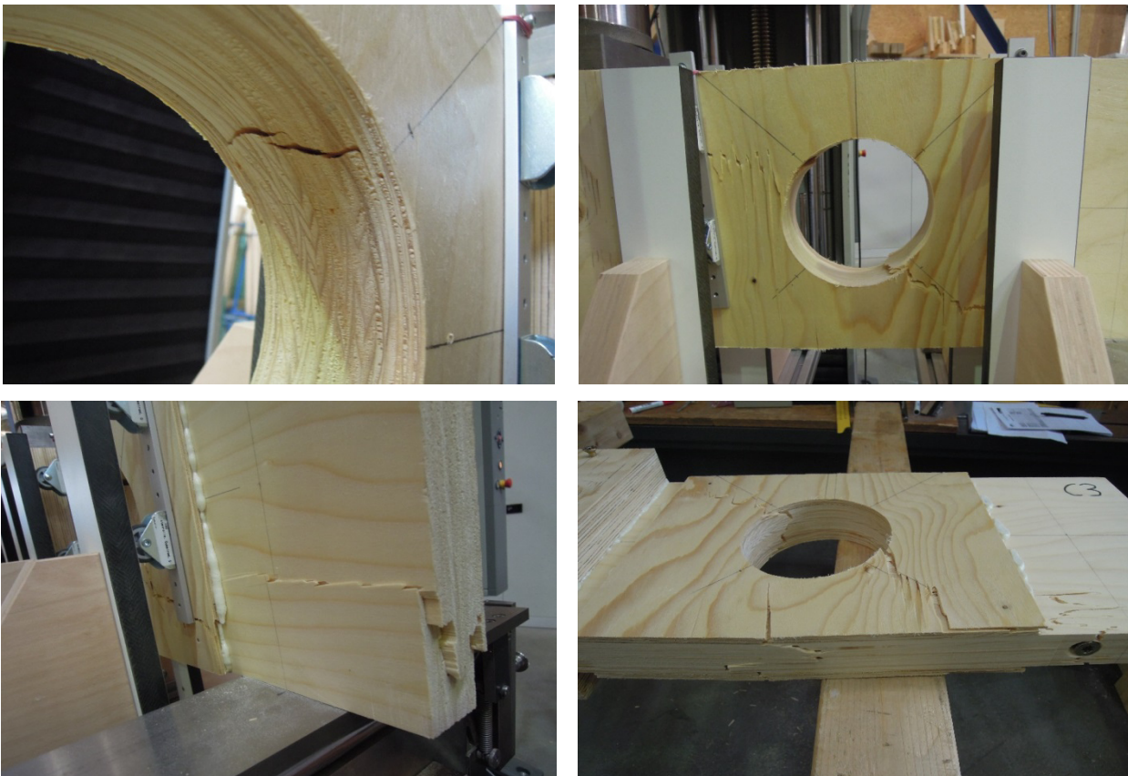
Abb. 3.12 Erstrisse im Trägerquerschnitt bei C3 (oben links), Aufreißen der Verstärkungsplatten bei C1 (oben rechts), Schubversagen bei C2 mit gleichzeitigem Biegeversagen im Durchbruchsbereich (unten links) und Biegebruch im Nettoquerschnitt bei C3
