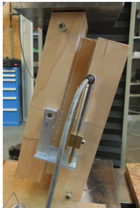
Abb. 4.5 Position des Messsystems bei den Scherprüfkörpern
