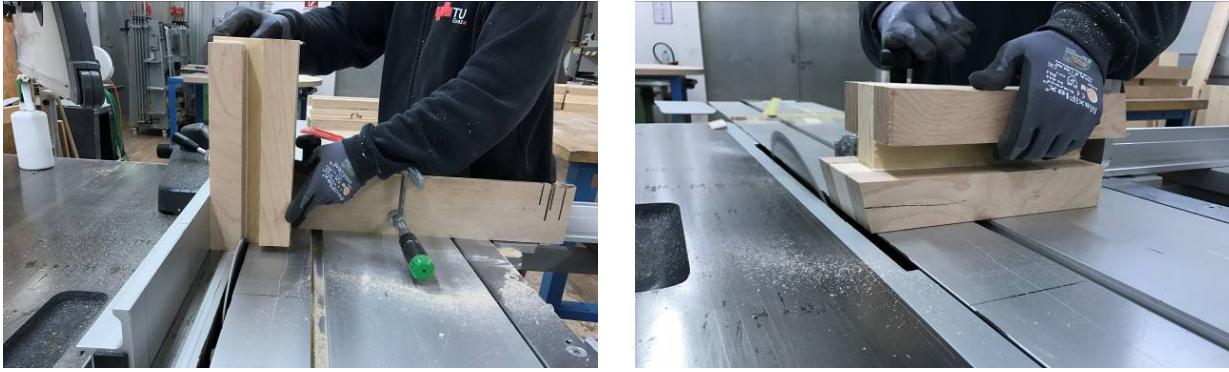
Abb. 2.11 Zuschneiden der Prüfkörper auf die endgültige Form
