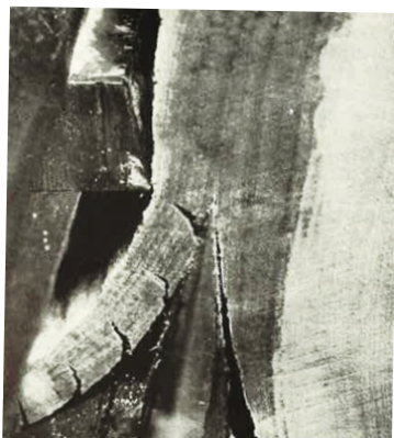
Abb. 1.7 Vergrößerte Ansicht eines Schälmessers mit loser Druckleiste (links) und andgedrückter Druckleiste (rechts) beim Schälen eines 7,9 mm starken Gelbbirkenfurniers (Kollmann, 1955)
