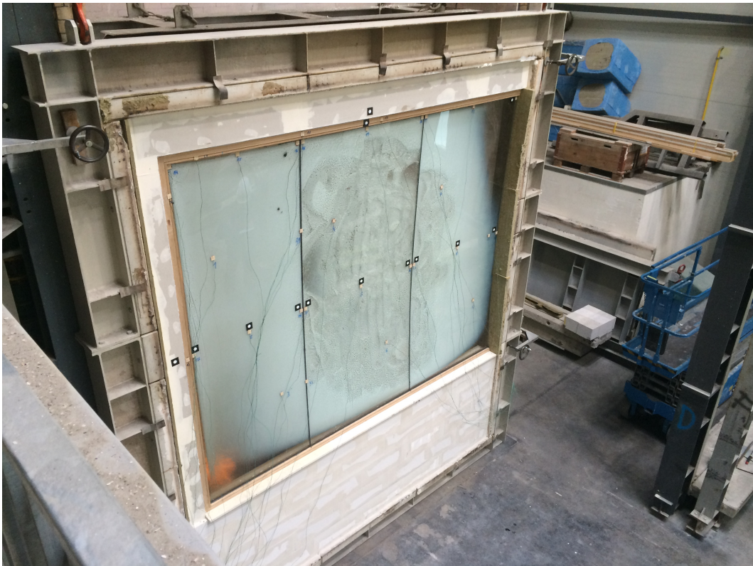
Abbildung 1.3: Feuerwiderstandsprüfung von Brandschutzglas
