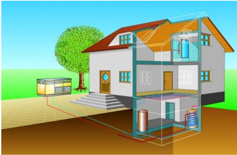
Abbildung 10: Sogenannte Luftwärmepumpen, die auf die Wärmequelle Luft zurückgreifen, sind besonders einfach zu installieren [WPAQ 2016]
