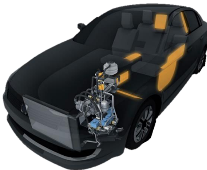
Abbildung 47: Energieeffiziente Klimatisierung von Elektrofahrzeugen [ATZ 2013]
