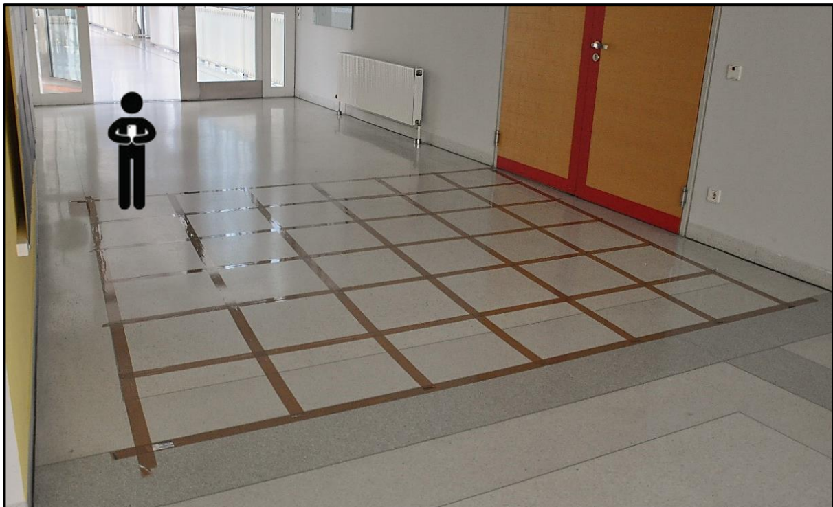
Abb. 37 Aufgeklebtes Messfeld im Korridor der TU-Graz (Steyrergasse 30)
